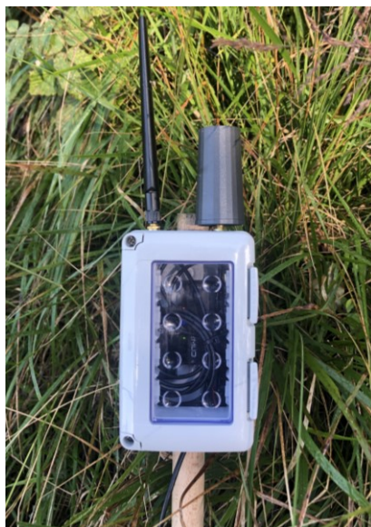
Figura 14. Rover con antenna LoRa (sinistra) e GNSS-RTK (destra).
