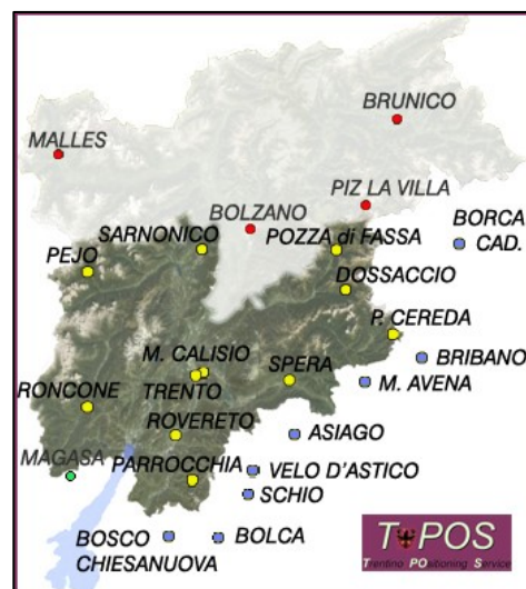
Figura 2. Rete stazioni GNSS permanenti Provincia autonoma di Trento (TPoS)
