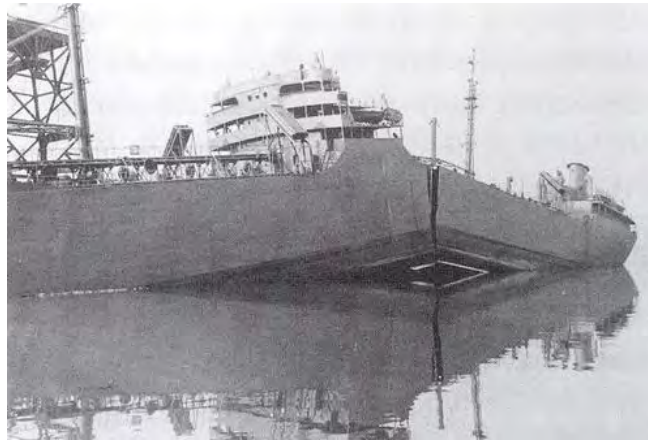
Fig.2.31: Rottura di schianto della petroliera Schenechtady, causata da una frattura innescatasi in corrispondenza della giunzione con il corso di cinta di una piastra irrigidente a dritta il ponte di coperta. Portland, Oregon, 1942.
