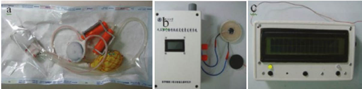
Fig. 2.17: Dispositivo AASS: (a) sfintere anale artificiale, (b) Trasmissione di energia transcutanea, (c) controllo esterno del dispositivo [50].
