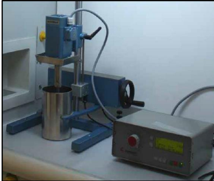
Figura 5.1 Dispersore a lama Dispermat® Tu
