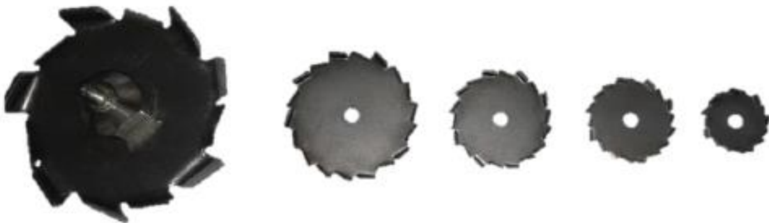
Figura 5.7 Dischi per dispersione disponibili in laboratorio
