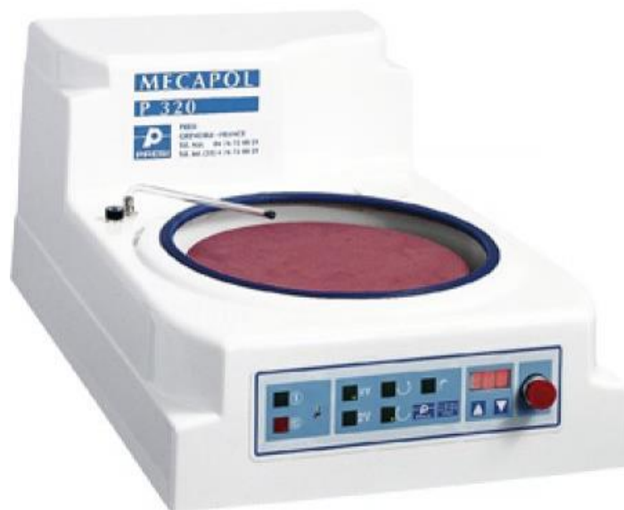
Figura 5.15 Lucidatrice Mecapol P320
