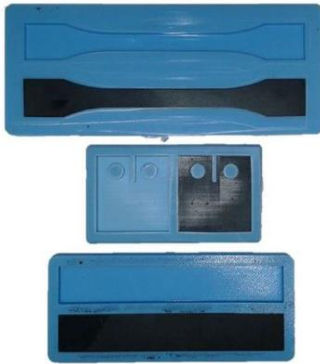
Figura 5.13 Stampi per la realizzazione di provini: (a) Dog Bone, (b) Compact Tension, (c) provino per misurazioni elettriche
