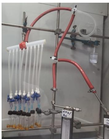
Figure 8: sistema per degasare
