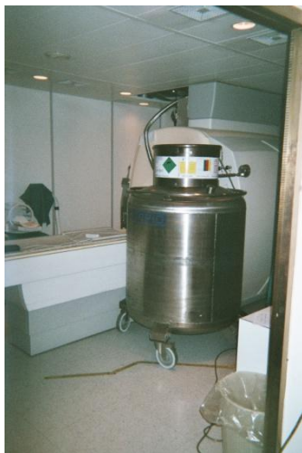
Figura 2.4 - Magnete superconduttore durante le operazioni di rabbocco dell'elio liquido
