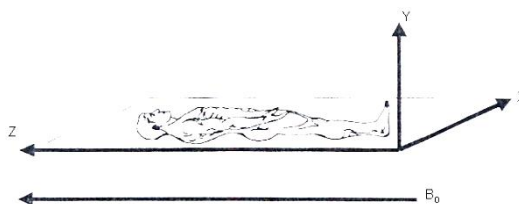
Figura 1.3 - Disposizione degli assi in un tomografo RM
