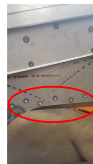
Figura 4.29 Sbavatura del metallo
