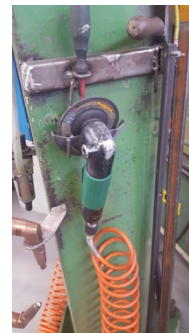
Figura 4.32 Sostituzione del disco della mola con perdita di tempo
