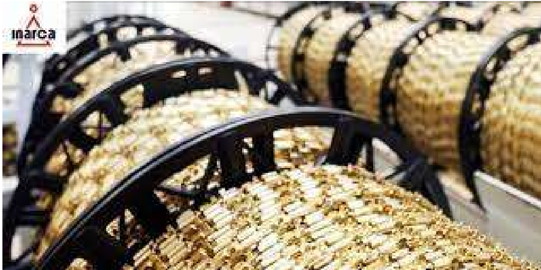
impianto di galvanizzazione a telaio automatico 347
