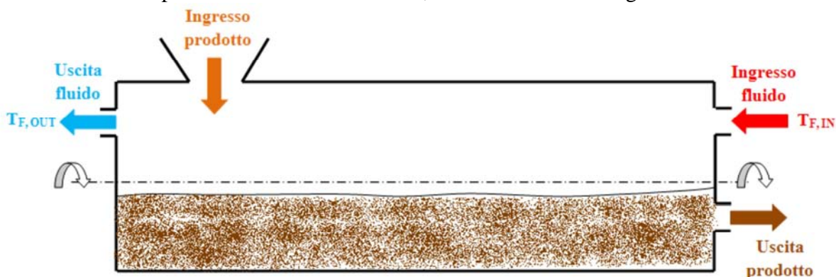
Figura 4.1. Schema semplificato di un essiccatore a tamburo rotante, con circolazione in controcorrente della frazione solida e dei fumi di combustione.
