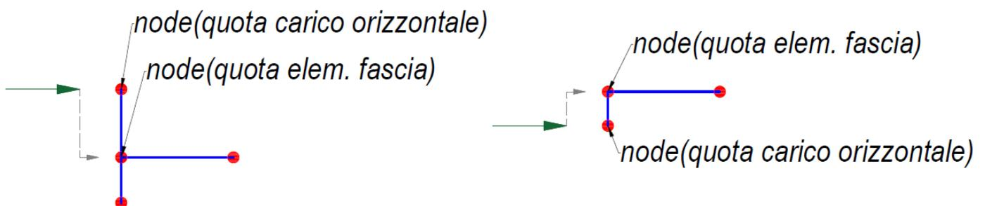
Figura 29 Trasporto del carico orizzontale in zona nodale rigida
