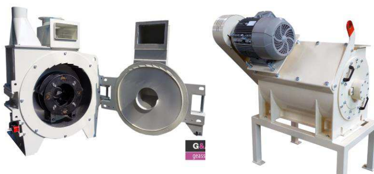
Image 38: Un broyeur à marteau, à gauche la section avec les disques broyeurs, à droite l'appareil entier, depuis: https://www.geassrl.it/fr/project/moulin-a-marteaux/ consulté le 18/06/2023
