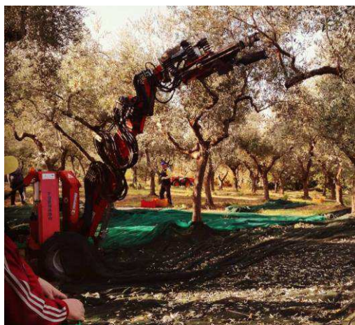
Image 36: Fabio Mancini, "récolte mécanisée à l'aide de bras mécanique ancré au tracteur", Lanciano (CH), Italie, 20/10/2019
