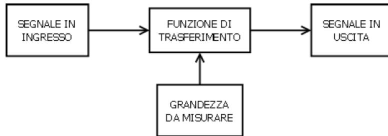
Figura 3.9 Schema a blocchi di un sensore fotonico
