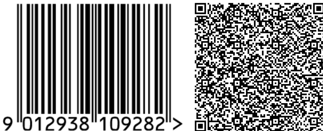
Figura 3.1 - Codici a barre "standard" e bidimensionale a confronto
