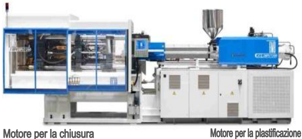
Figura 19 - disposizione dei motori in una pressa [5]
