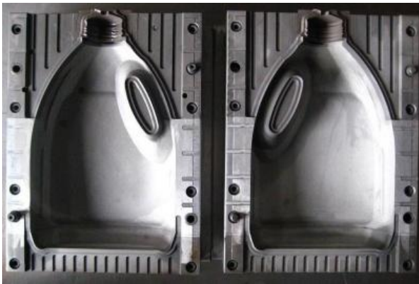
Figura 9.a - due semistampi di un flacone (stampo ad una sola figura)
