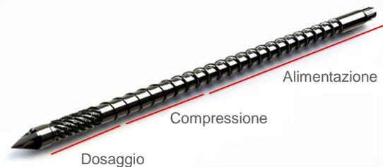
Figura 6 - zone di una vite a barriera
