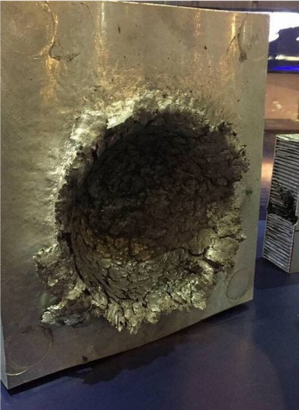
Sfera di alluminio ( d = 1.2 \text{ cm} ) a 6.8 \text{ km/s} — NASA
