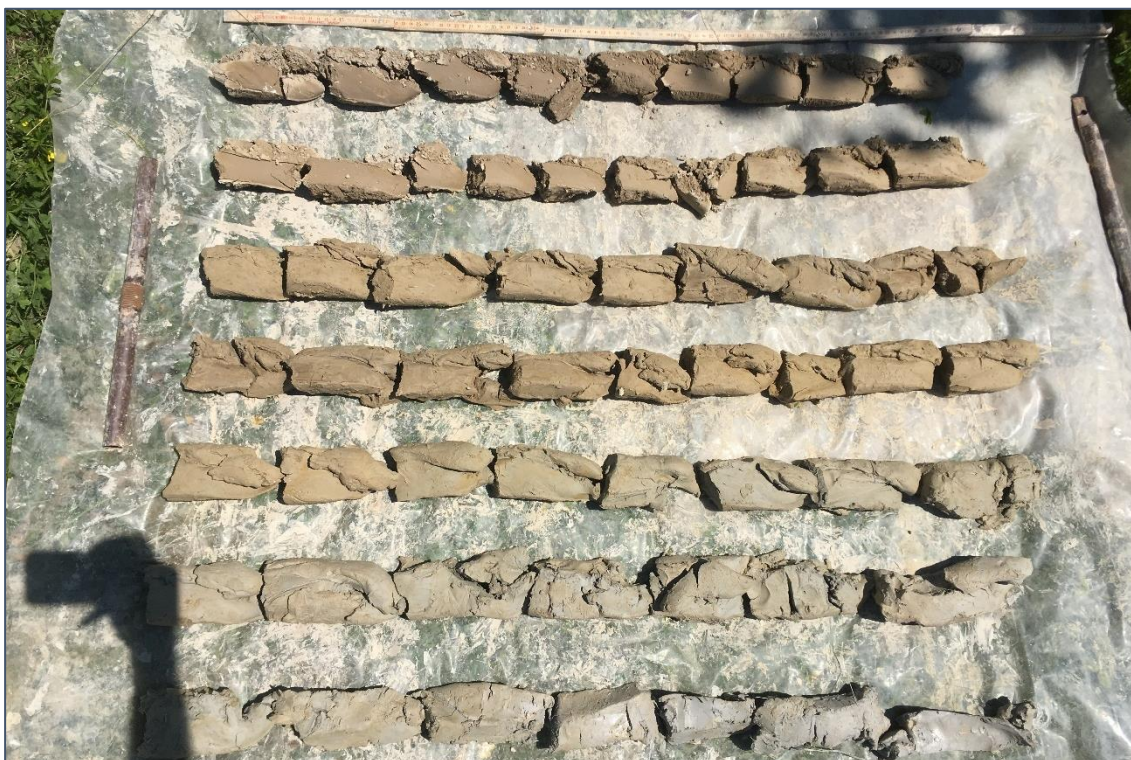
Figura 5.34: Fotografia del sondaggio ROND3 con profondità max. 7.00 m. Ogni spezzone misura 1 m.
