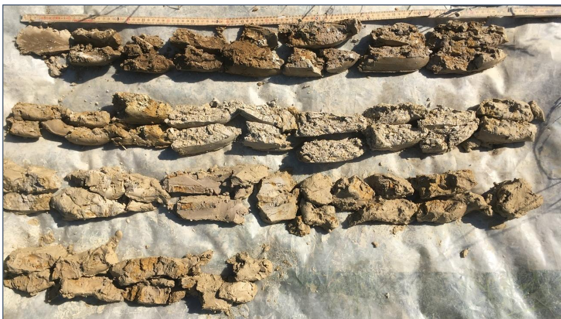
Figura 5.37: Fotografia del sondaggio ROND6 con profondità max. 3.20 m. Ogni spezzone misura 1 m.
