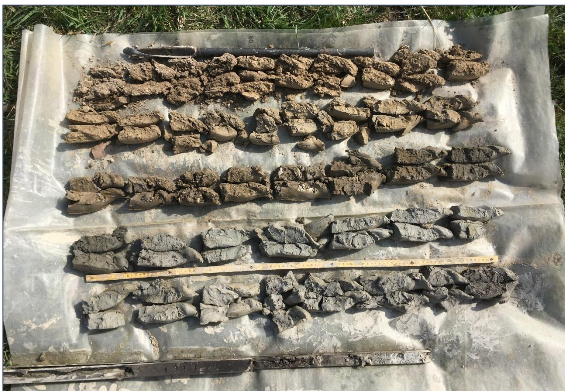
Figura 5.27: Fotografia del sondaggio MRZ2 con profondità max. 5.80 m. Ogni spezzone misura 1 m.
