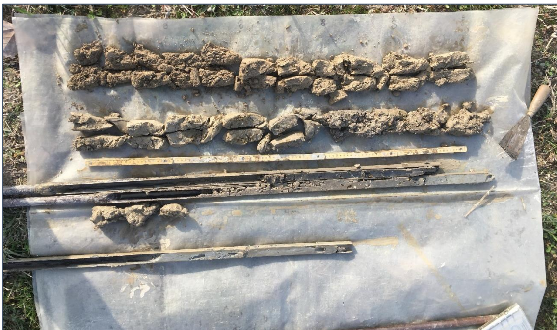
Figura 5.26: Fotografia del sondaggio MRZ1 con profondità max. 3.70 m. Ogni spezzone misura 1 m.
