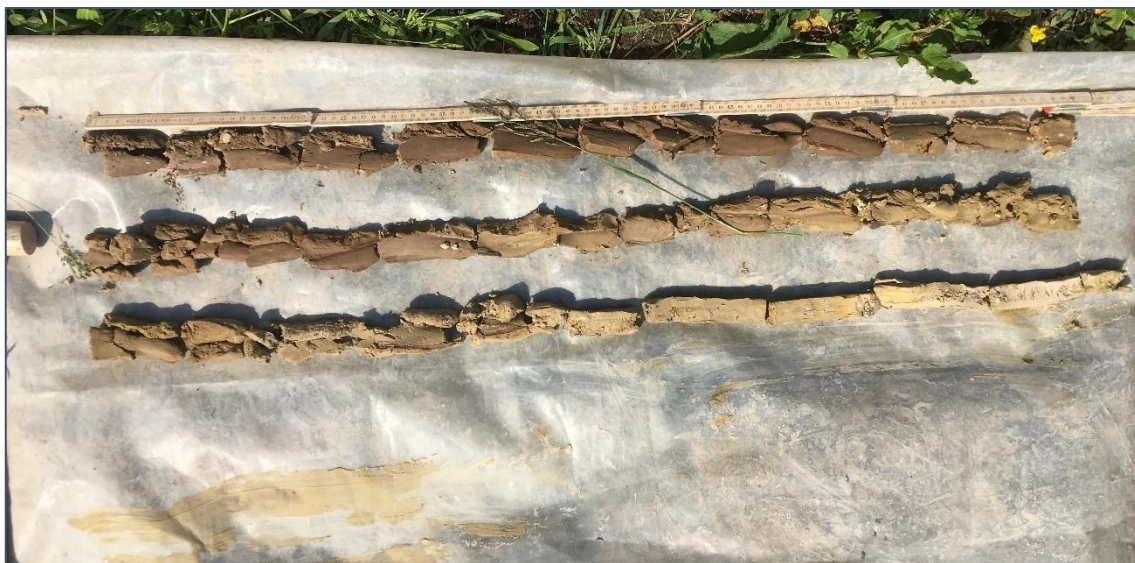
Figura 5.32: Fotografia del sondaggio ROND1 con profondità max. 3.20 m. Ogni spezzone misura 1 m.
