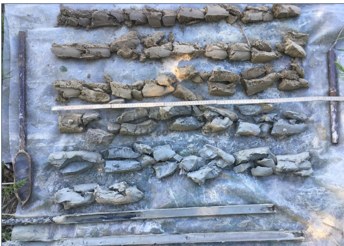
Figura 5.35: Fotografia del sondaggio ROND4 con profondità max. 6.80 m. Ogni spezzone misura 1 m.
