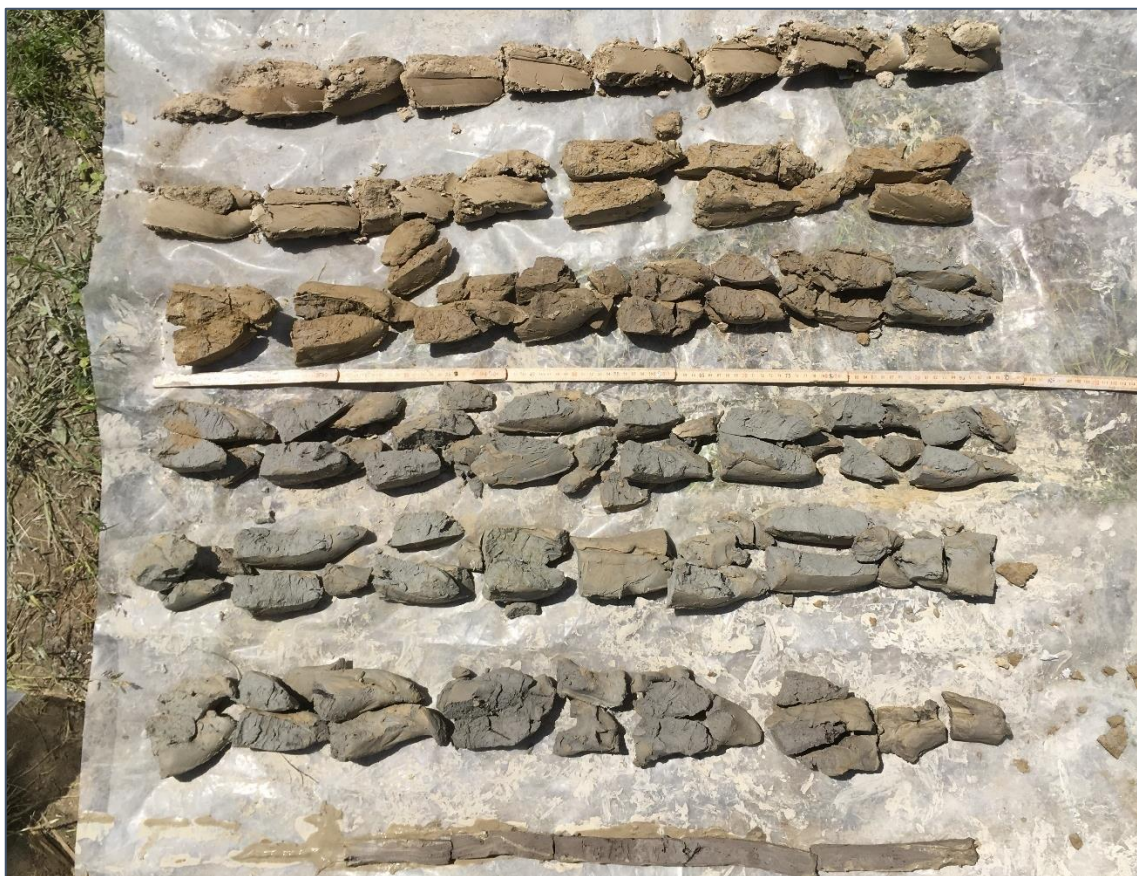
Figura 5.36: Fotografia del sondaggio ROND5 con profondità max. 7.00 m. Ogni spezzone misura 1 m.
