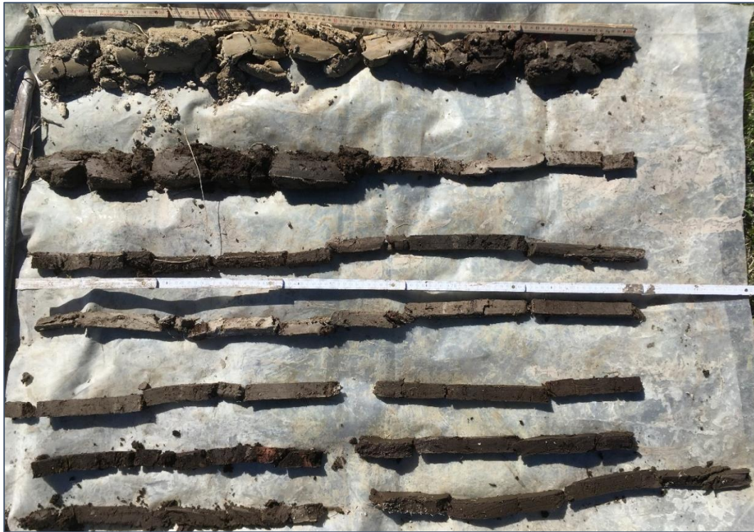
Figura 5.20: Fotografia del sondaggio RST2 con profondità max. 7.20 m. Ogni spezzone misura 1 m.
