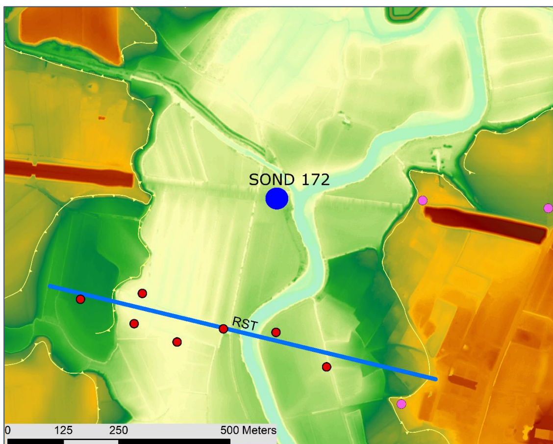
Figura 6.9: Stralcio del layer relativo ai dati DTM. In figura è riportata l'ubicazione del sondaggio preesistente SOND. 172. È riportata l'ubicazione del Transetto 1 - Rustighel (RST) (linea viola).
