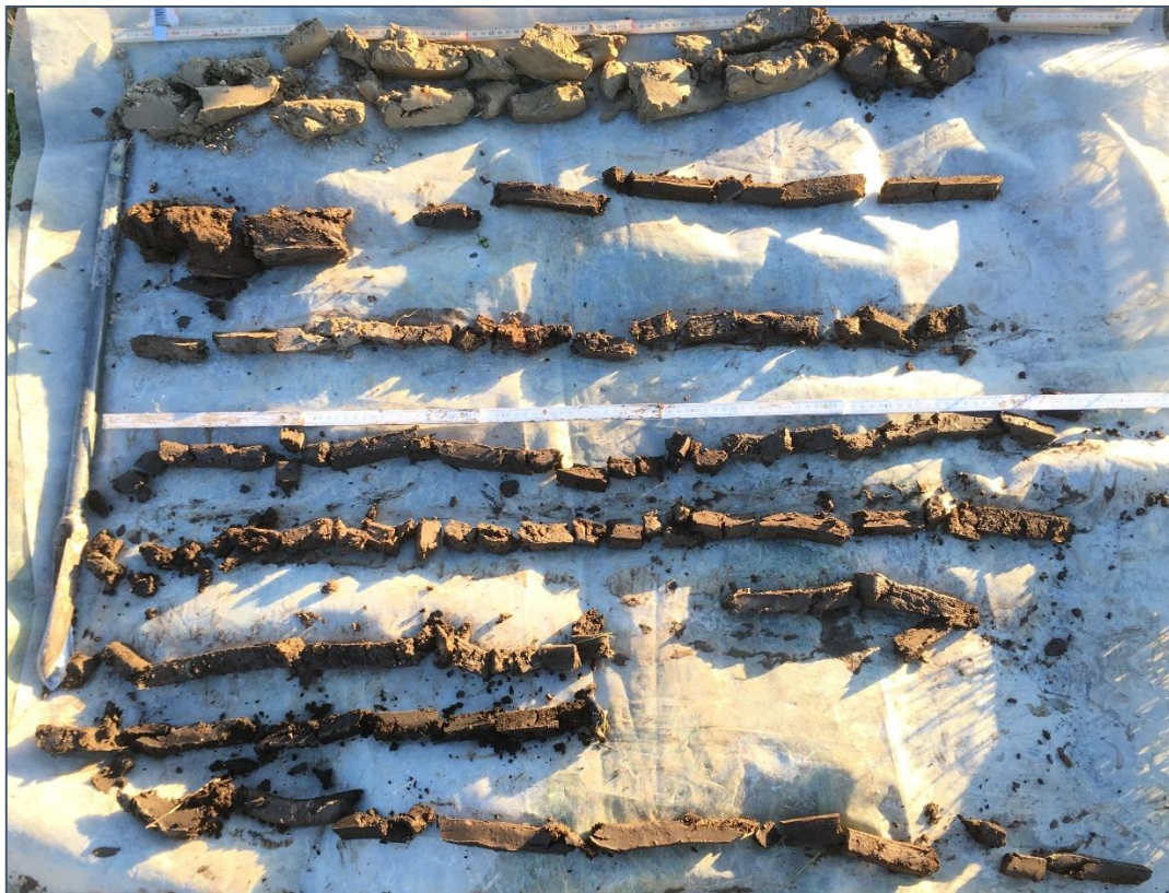
Figura 5.21: Fotografia del sondaggio RST3 con profondità max. 7.30 m. Ogni spezzone misura 1 m.
