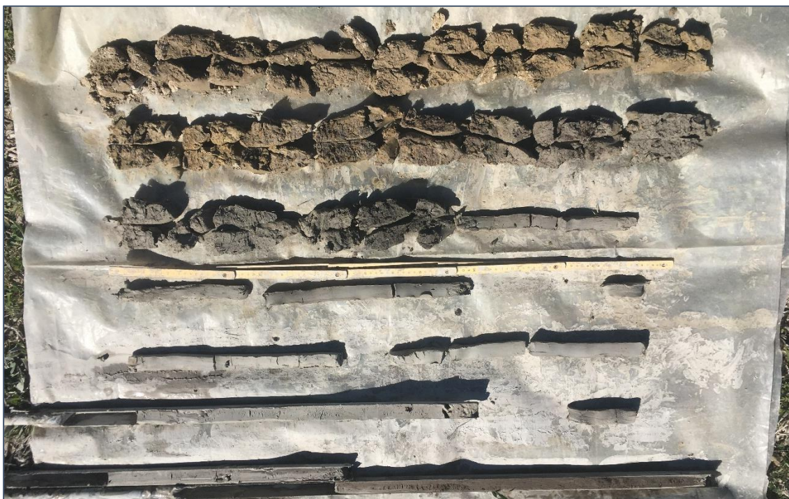
Figura 5.28: Fotografia del sondaggio MRZ3 con profondità max. 7.10 m. Ogni spezzone misura 1 m.
