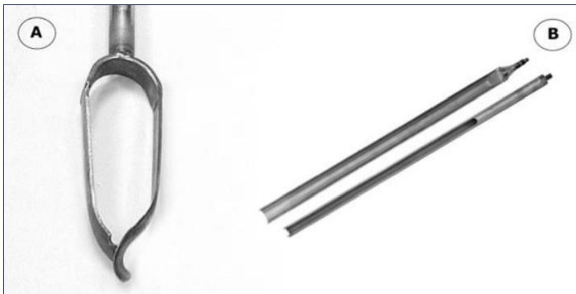
Figura 4.6: I due tipi di punta utilizzata dal carotatore olandese (da: www.eijkelkamp.com , modificata). A) punta tipo "Edelman"; B) punta tipo "Gauge".
