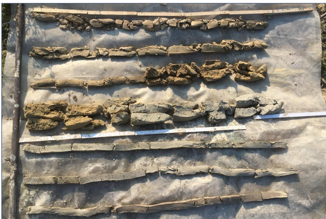
Figura 5.33: Fotografia del sondaggio ROND2 con profondità max. 7.00 m. Ogni spezzone misura 1 m.
