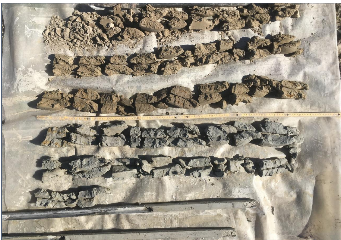
Figura 5.29: Fotografia del sondaggio MRZ4 con profondità max. 6.80 m. Ogni spezzone misura 1 m.
