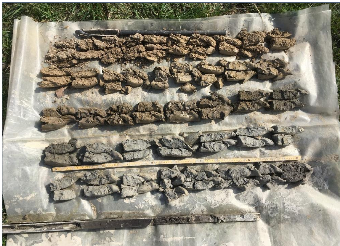
Figura 4.7: Esempio di stratigrafia eseguita con il carotatore olandese con l'utilizzo della punta "Edelman" e nella parte finale con la punta "Gauge". L'immagine riporta il sondaggio MRZ2 (profondità max.= 6.8 m dal p.c.) relativo al Transetto n.2 (Case Mariz). Il campione è suddiviso in intervalli, posti uno sotto l'altro, della lunghezza pari a 1 m.
