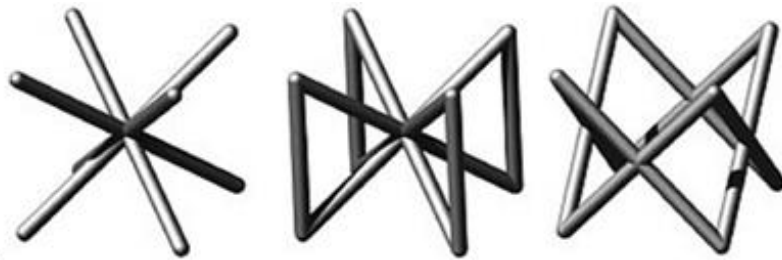
Figura 2.2: esempi di celle unitarie strut-based : da sinistra sono visibili BCC, BCCZ, FCC [4]
