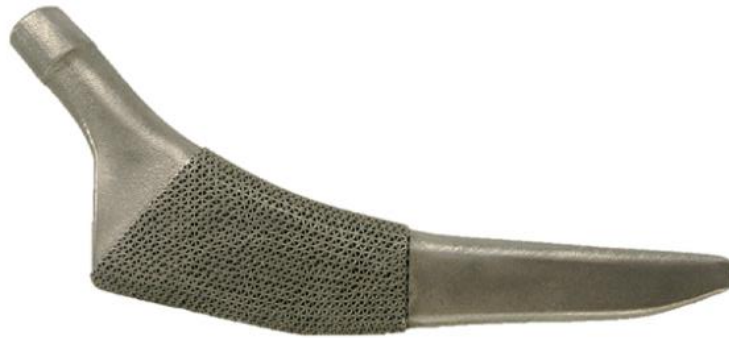
Figura 2.5: esempio di impianto protesico in materiale a struttura reticolare in lega di titanio [5]
