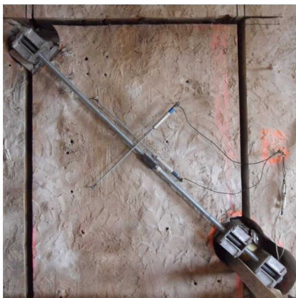
Fig. 2.7 – Prova di compressione diagonale eseguita in laboratorio (sinistra) (Modena et al., 2000b) e prova di compressione diagonale eseguita in sito (destra) (Cappello, 2011).
