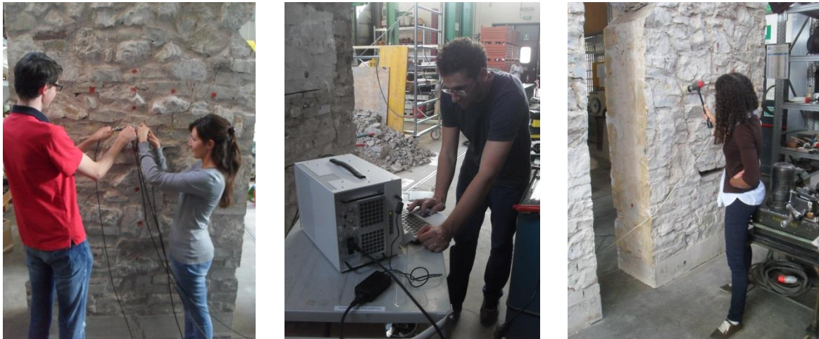
Fig. 7.58: Alcune fasi di esecuzione della prova tomografica (Zanchetta, 2013).
