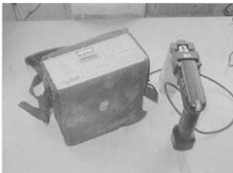
Fig. 2.17 – Strumentazione per l'esecuzione della prova penetrometrica (RILEM, 2004).
