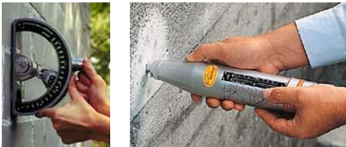
Fig. 2.28 – Sclerometro a pendolo di Van Der Klugt (sinistra) e sclerometro a percussione di Schmidt (destra) (Cappello, 2011).
