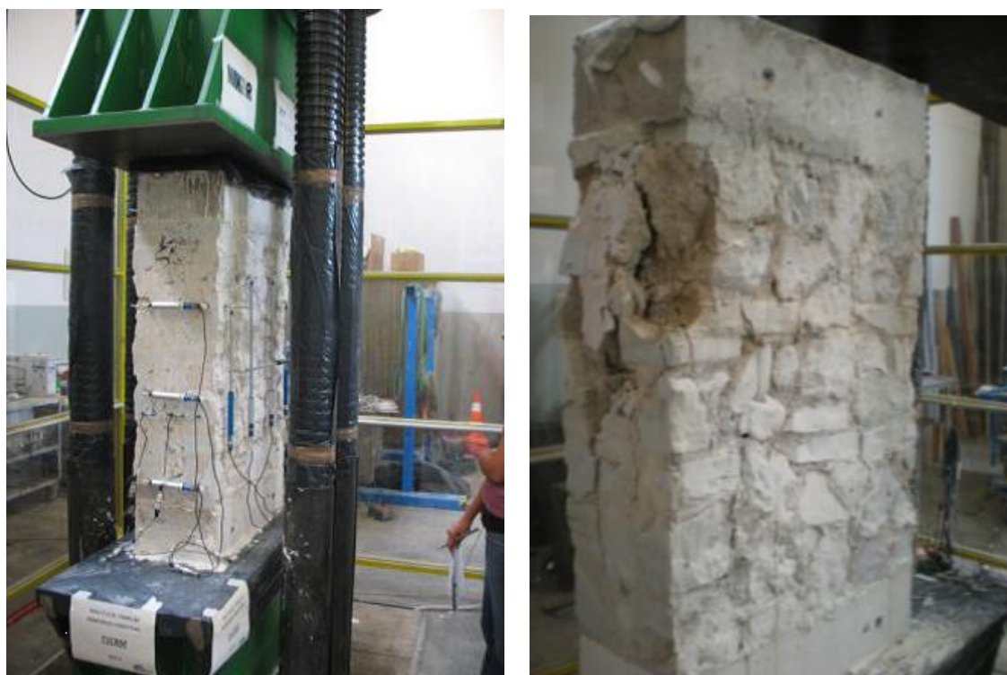
Fig. 2.4 – Prova di compressione diretta monoassiale eseguita in laboratorio (sinistra) e relativo esito (destra) (Santunione e Secchiero, 2011).
