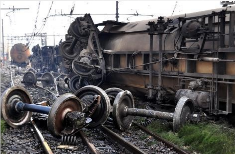
Strage di Viareggio: 32 morti. Causa: cedimento dell'asse di un carrello.
