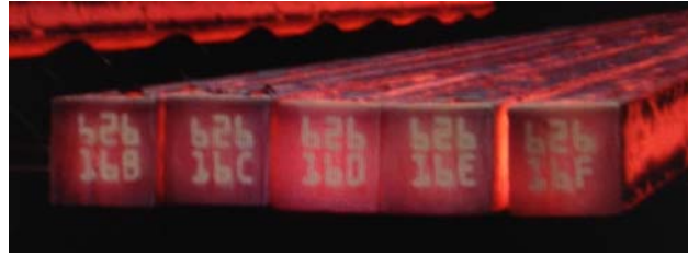
Figura 5 Marcatura a spruzzo di polvere metallica
