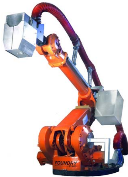
Figura 6 Versione robot di una macchina di marcatura a singolo ugello
