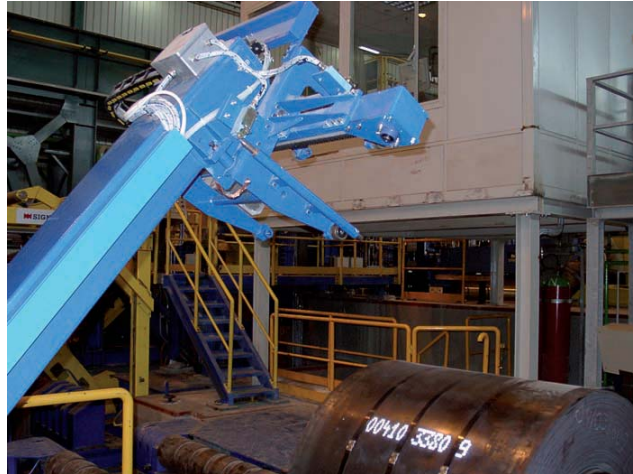
Figura 11 Versione a pavimento di una macchina per la marcatura con tecnologia TEMA multi
