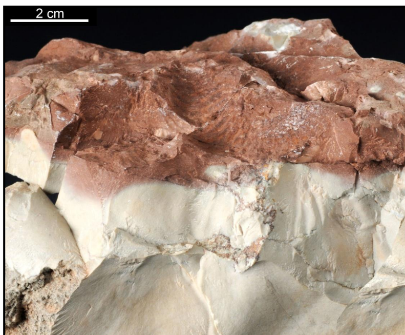
Fig.22 - Dettaglio della bioturbazione su un campione di roccia proveniente dallo strato GC2.
