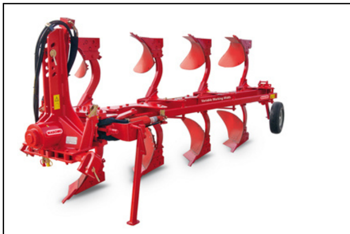
Figura 5.0.5 Aratro reversibile portato modello Sisto , marca Maschio Gaspardo
