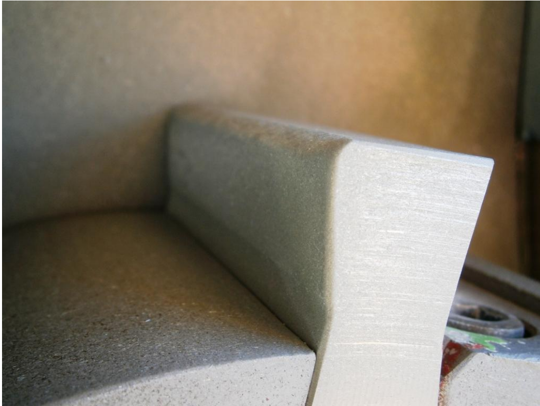
Fig. 4.9 – Martello parzialmente usurato. L'usura agisce sullo spigolo che subisce il contatto con le rocce.
