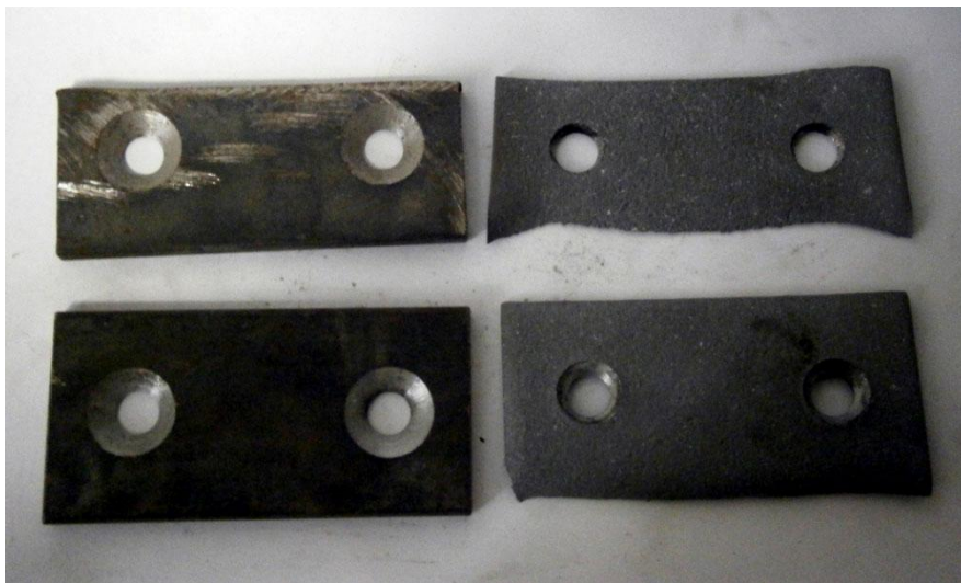
Fig. 5.13 – Confronto tra piastre nuove (a sinistra) e piastre usurate (a destra).
