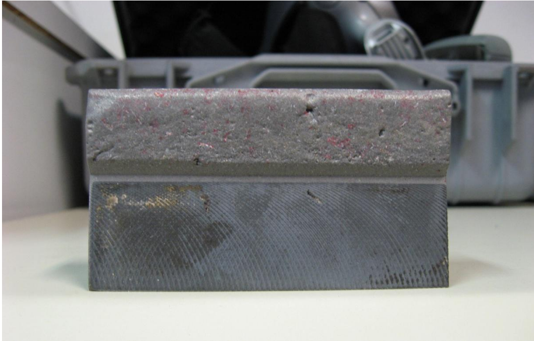
Fig. 4.8 – La presenza di punti erosi con tracce di vernice rossa sulla superficie frontale è indice di un processo di frantumazione corretto.
