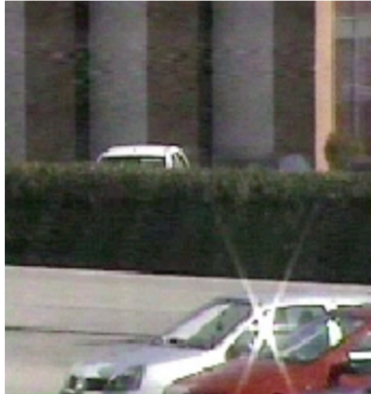
Figura 8.12: Ritaglio di un frame che riassume i problemi principali avuti durante le prove in real time con la telecamera PTZ. In alto si notano sia il disturbo che il rumore del video. In basso, sul finestrino dell'auto parcheggiata, si vede il riflesso dovuto alla luce incidente del sole.
