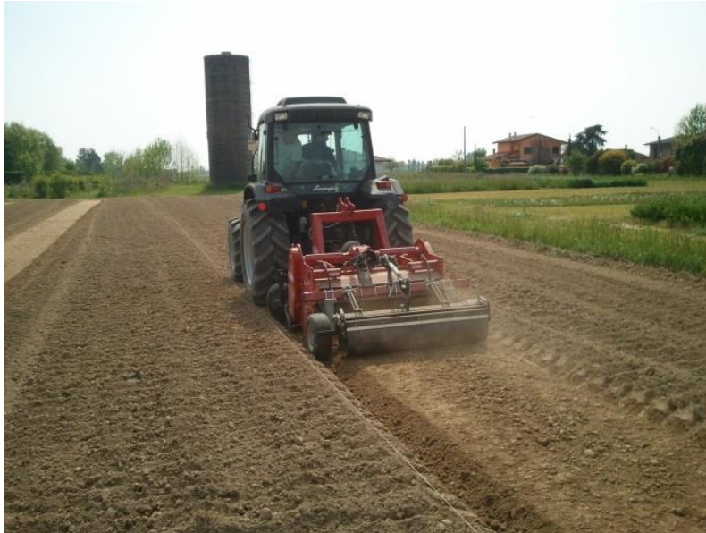
Figura 7. Baulatrice Forigo D35-130 usata nella prova di questa tesi.
