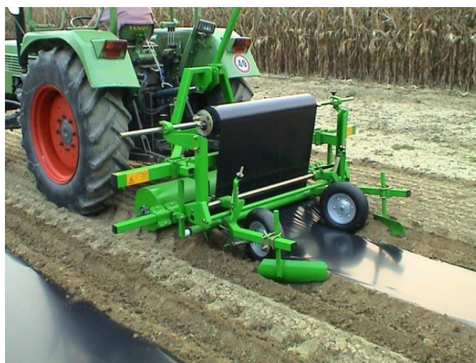
Figura 2. Esempio di pacciamatrice (Fonte: Sfoggia, 2013).
