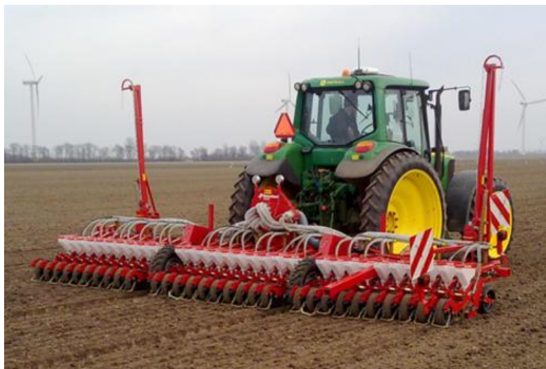
Figura 9. Seminatrice pneumatica con 3 sezioni di semina utilizzabile sia su terreno piatto che aiuolato (Fonte: Kverneland, 2014).
