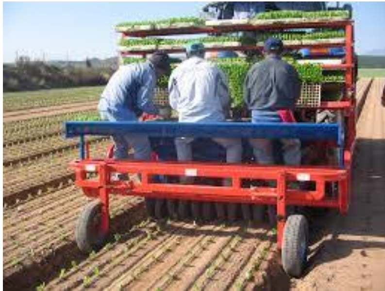
Figura 8. Trapiantatrice per aiuola singola (Fonte: Ferrari, 2011).
