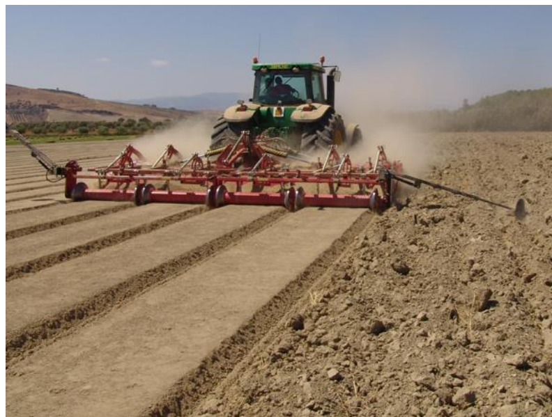
Figura 6. Baulatrice a 4 sezioni (Fonte: Massano, 2011).
