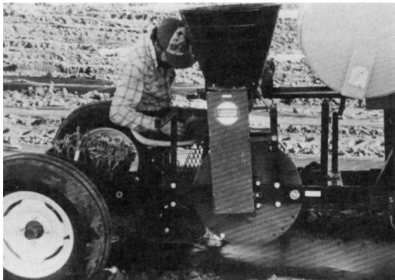
Figura 4. Trapiantatrice con tasca (Fonte: Mc Crawe Motes, 1991).
