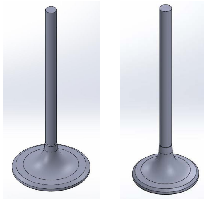
Figura 4.5 – Immagini SOLIDWORKS della valvola di aspirazione a sinistra e della valvola di scarico sulla destra
