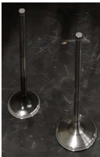
Figura 3.4 – Foto delle valvole a fungo. A sinistra la valvola di scarico a destra la valvola di aspirazione
