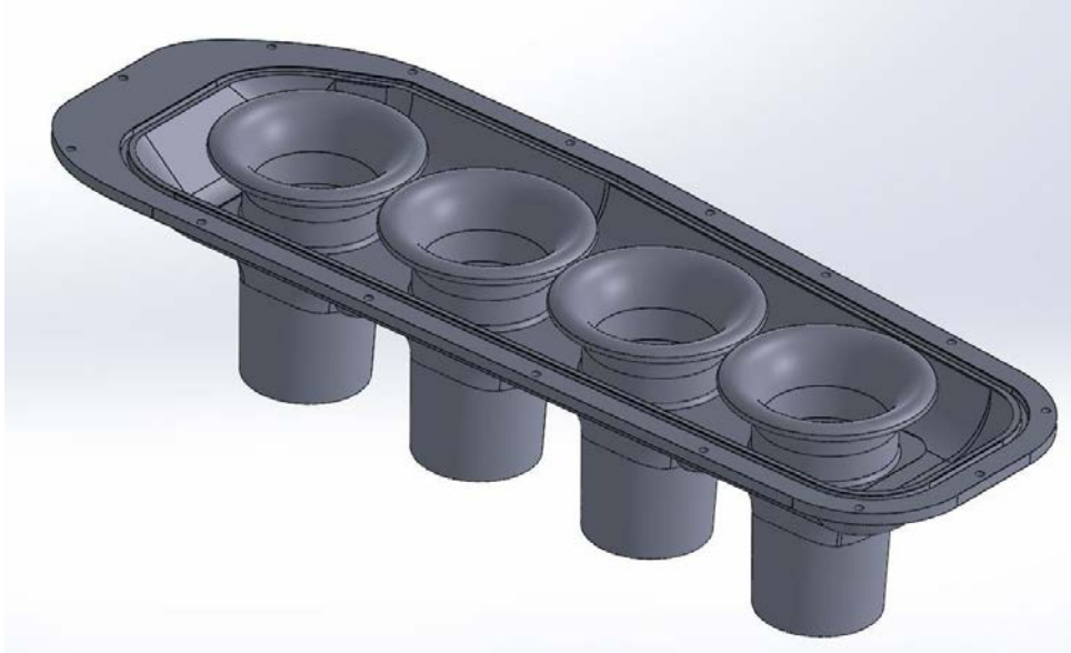
Figura 3.9 – Rappresentazione interna dell'Airbox. Sono ben visibili le quattro trombette di aspirazione che portano l'aria ai cilindri
