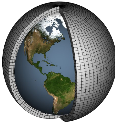
Figura 6: Rappresentazione della griglia tridimensionale del globo terrestre su cui si basa la modellazione climatica
