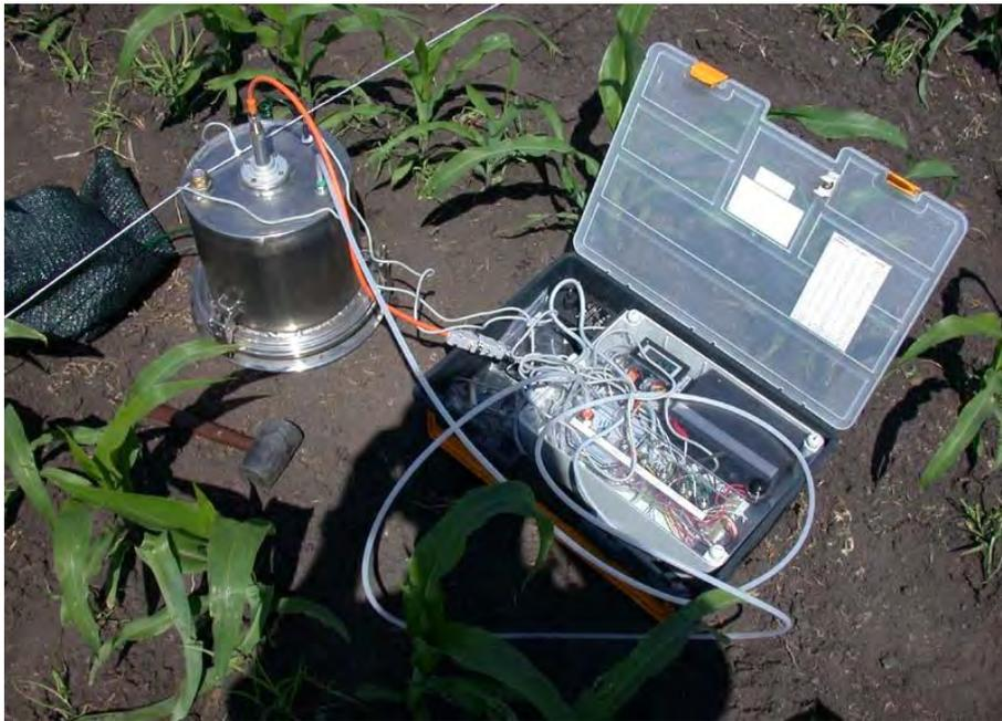
**Figura 2.14: camera di misurazione dei flussi di CO<sub>2</sub>**
