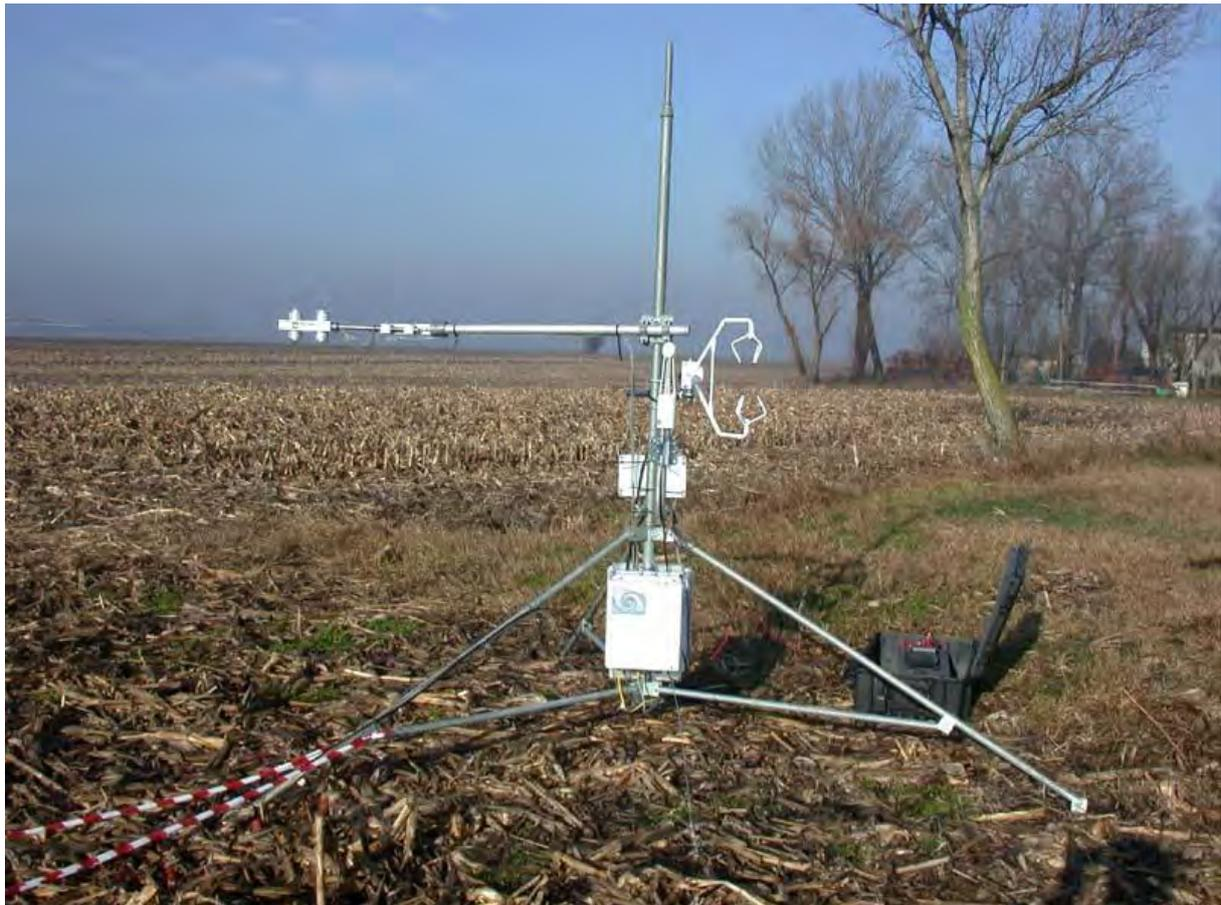
**Figura 2.15: strumento per misurazioni di flussi di CO<sub>2</sub> con tecniche micrometeorologiche**
