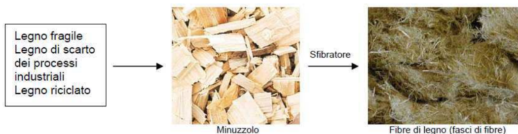
Fasi produttive delle fibre di legno.
