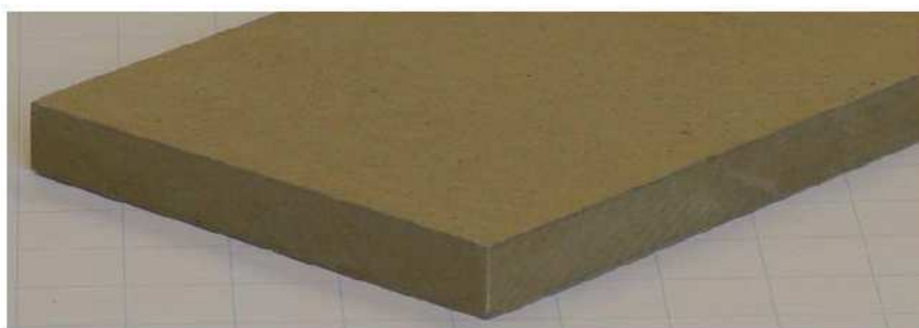
Pannello di fibra di legno a media densità (MDF).
