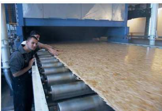
Pannello „ininterrotto“ sui rulli della pressa
