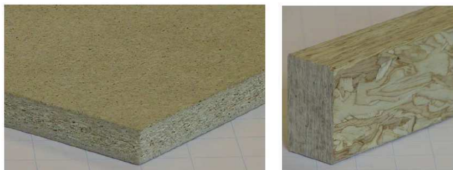
Pannello piano pressato incollato con resine sintetiche (sinistra) e pannello di trucioli a striatura (destra).
