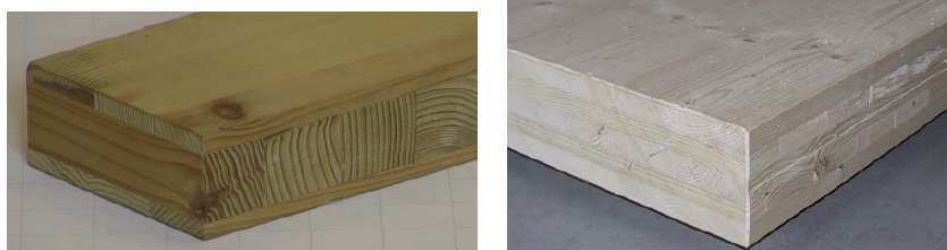
Pannelli di legno massiccio a tre strati (sinistra) e pannello di legno compensato di tavole a cinque strati (destra).
