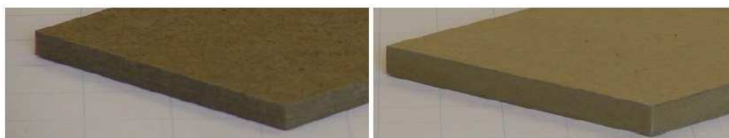
Pannello di fibra di legno duro (sinistra) e medio – duro (destra).
