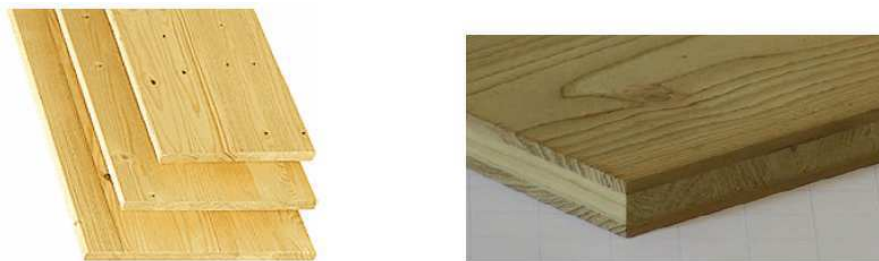
Pannelli di legno massiccio monostrato (sinistra) e a tre strati (destra).
