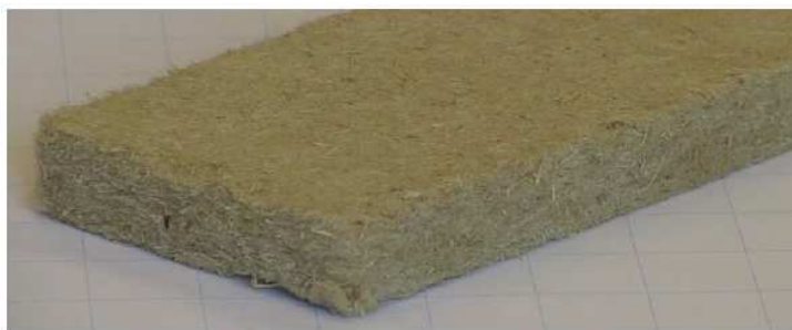
Pannello di fibra di legno poroso.
