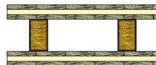
Pannello di compensato di tavole con nervature di lamellare incollato e variante a sezione a cassone.
