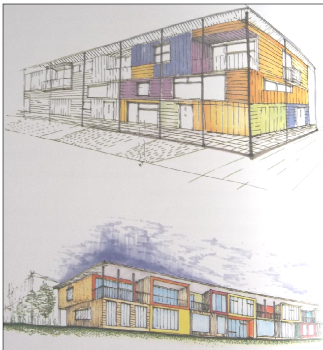
Esempi di composizione architettonica con moduli prefabbricati per edifici a due e tre piani.
