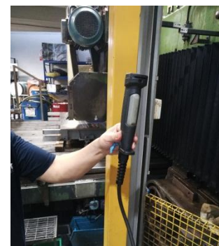
Figura 7.5.3 : pulsante a tre stadi per lavorazioni in prossimità
