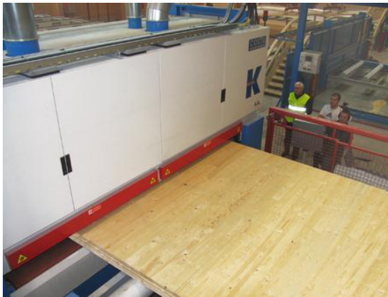
Figura 2.2.5 : Lavorazione pannelli extra - larghi
