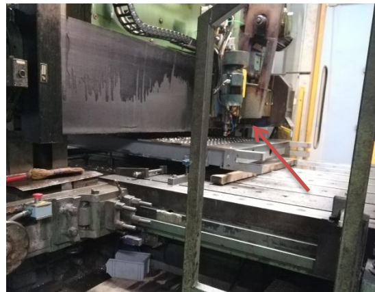
Figura 7.6.2 : zona di lavoro accessibile con pulsantiera mobile. Le lavorazioni possibili sono solo di foratura
