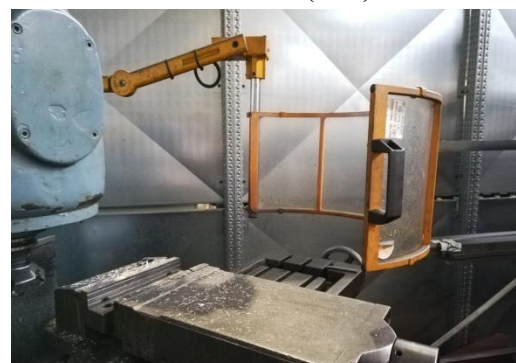
Figura 7.3.2 : arresto di emergenza (sopra) e riparo interbloccato (sotto)
