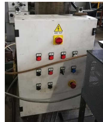
Figura 7.9.2 : pulsantiera di comando
