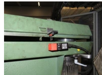
Figura 7.8.3 : vano cinghie interbloccato
