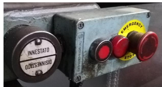
Figura 7.3.2 : arresto di emergenza (sopra) e riparo interbloccato (sotto)
