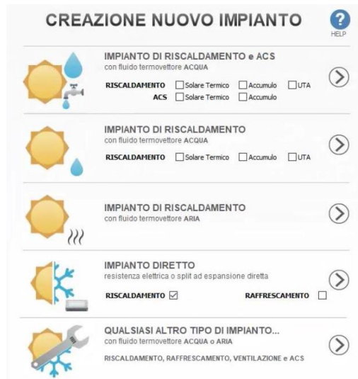
Figura 3.28: Tipologie di impianti delle centrali termiche
