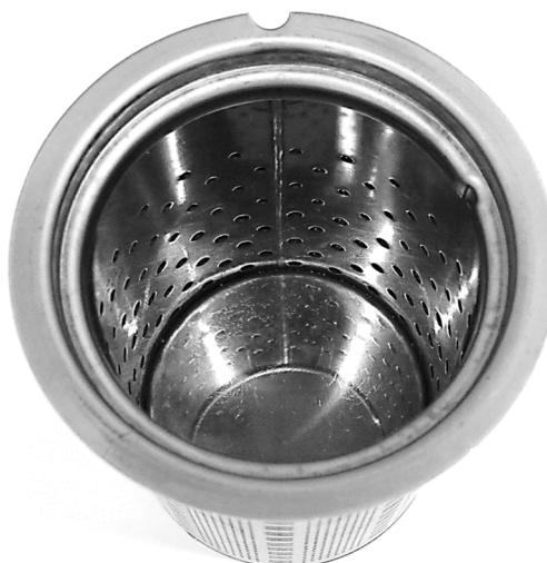
Figura 38 – Bruciatore in acciaio tranciato, dall'interno si nota il distributore, un'ulteriore lastra d'acciaio forata a fori larghi per distribuire equamente la miscela tutt'attorno al piano del bruciatore
