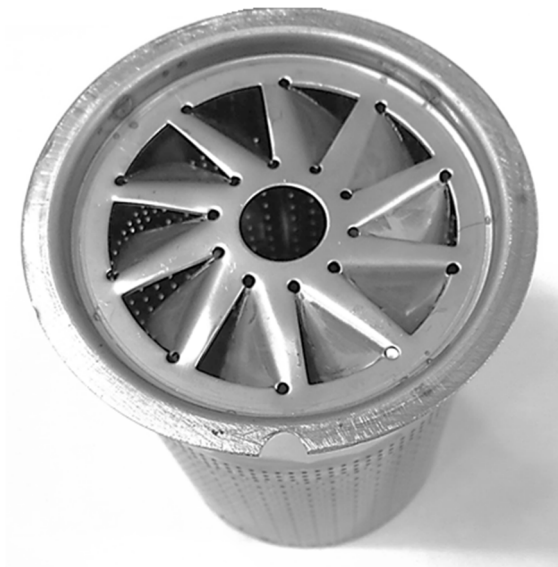
Figura 40 - Bruciatore in acciaio tranciato single sheet, vista dello swirler iniziale
