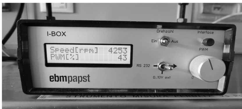
Figura 35 - Strumento per la regolazione della velocità del ventilatore
