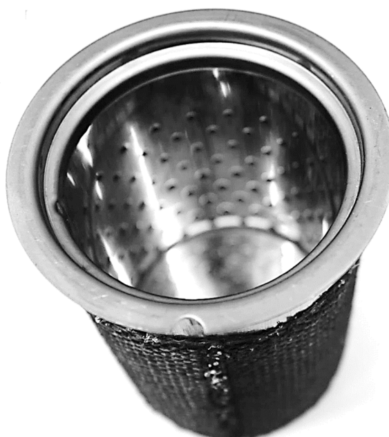
Figura 42 – Bruciatore rivestito con fibra tessuta. Dall'interno si nota il distributore, prova che è uno standard rivestito
