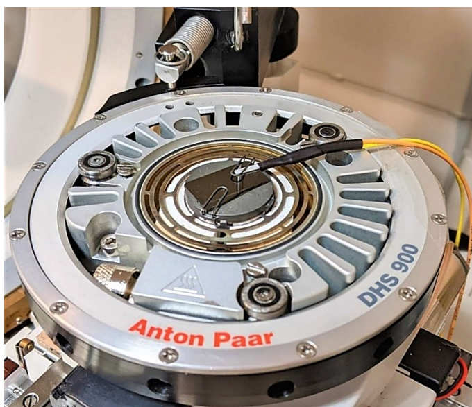
Figura 3.10: per stimare la temperatura dei film sottili di VO 2 caratterizzati al diffrattometro, la piastra riscaldante Anton Paar DHS 900 è stata calibrata tramite una termoresistenza Pt-100.
