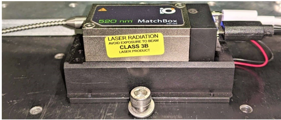
Figura 3.16: diodo laser in cw usato in questa tesi per il pompaggio a 520 nm degli ioni \text{Er}^{3+} in allumina. La luce verde fuoriesce da sinistra attraverso la fibra ottica grigia.
