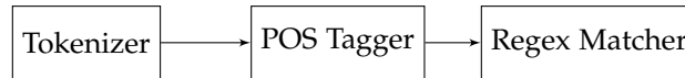
Figura 1.: Schema a blocchi di un tipico sistema di Information Extraction, (figura presa parzialmente da [6, ch. 3, pag. 80])
