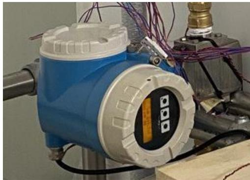
Figura 7. Immagine del misuratore di portata
