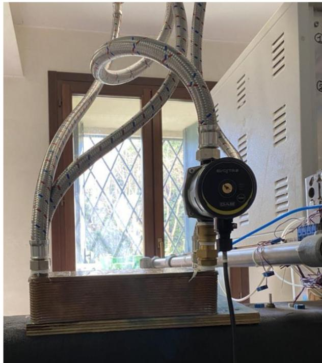
Figura 8. Immagine dello scambiatore a piastre
