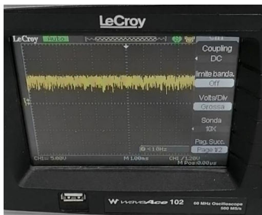
Figura 4.9d: segnale amplificato e invertito
