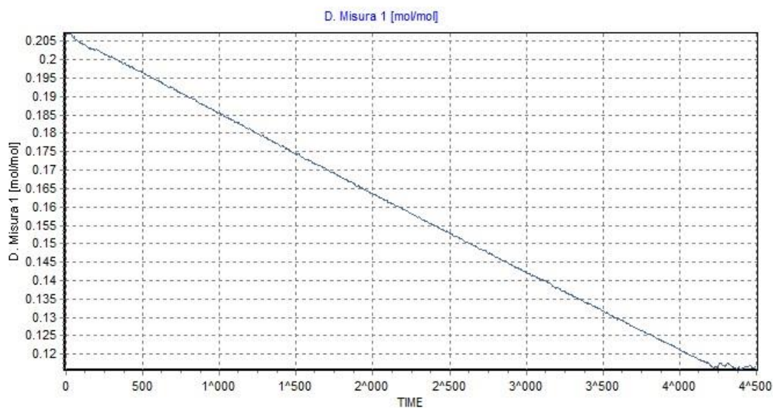
Fig. 5.5: Concentrazione O2 nel locale ciclotrone
