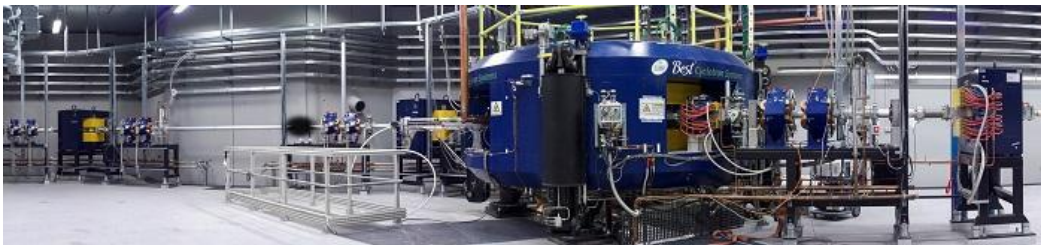
Fig.1.5: il ciclotrone Best 70p nel bunker di SPES presso i LNL
