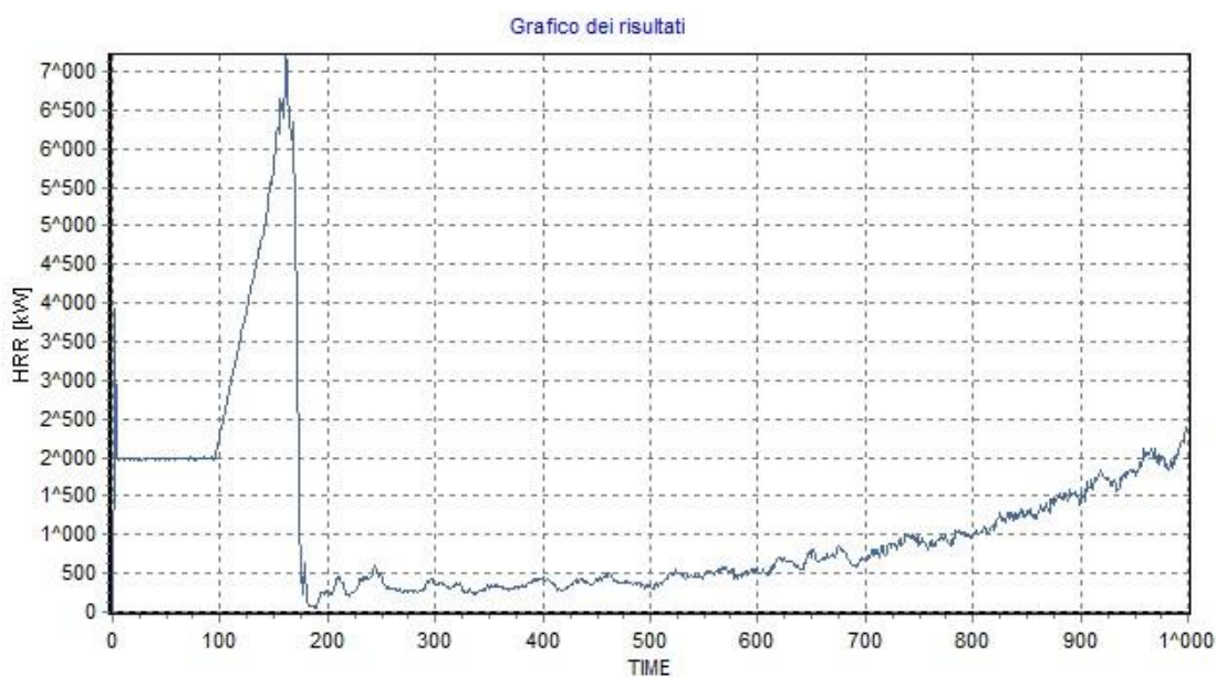
Fig. 5.7: HRR bunker con aspirazione accesa
