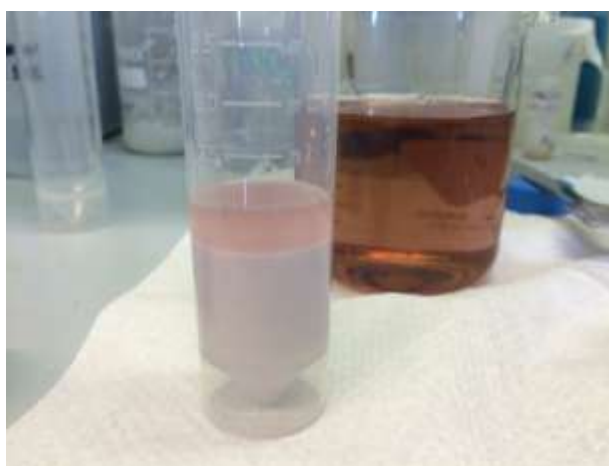
Figura 2.13: Sali di neodimio dopo separazione e centrifugazione
