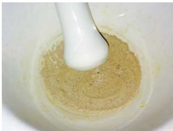
Figura 4.8: Condensatori dopo trattamento termico e macinazione
