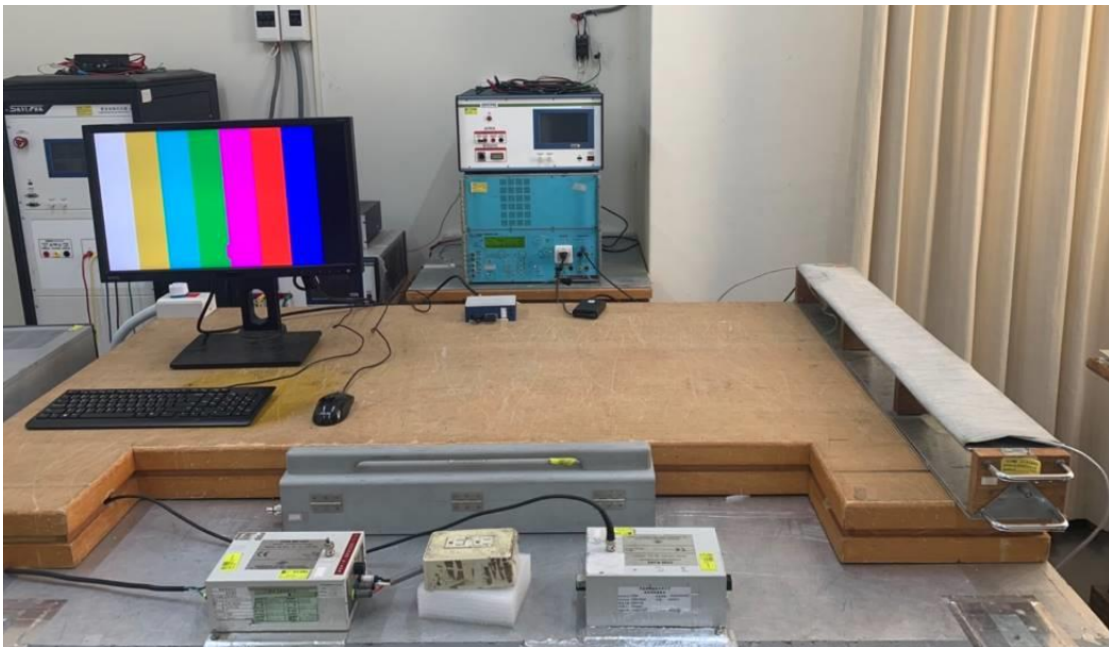
Figura 3.13: Esempio di set-up reale per un'apparecchiatura di tipo table-top. Sulla destra si può notare il morsetto di accoppiamento capacitivo. [15]
