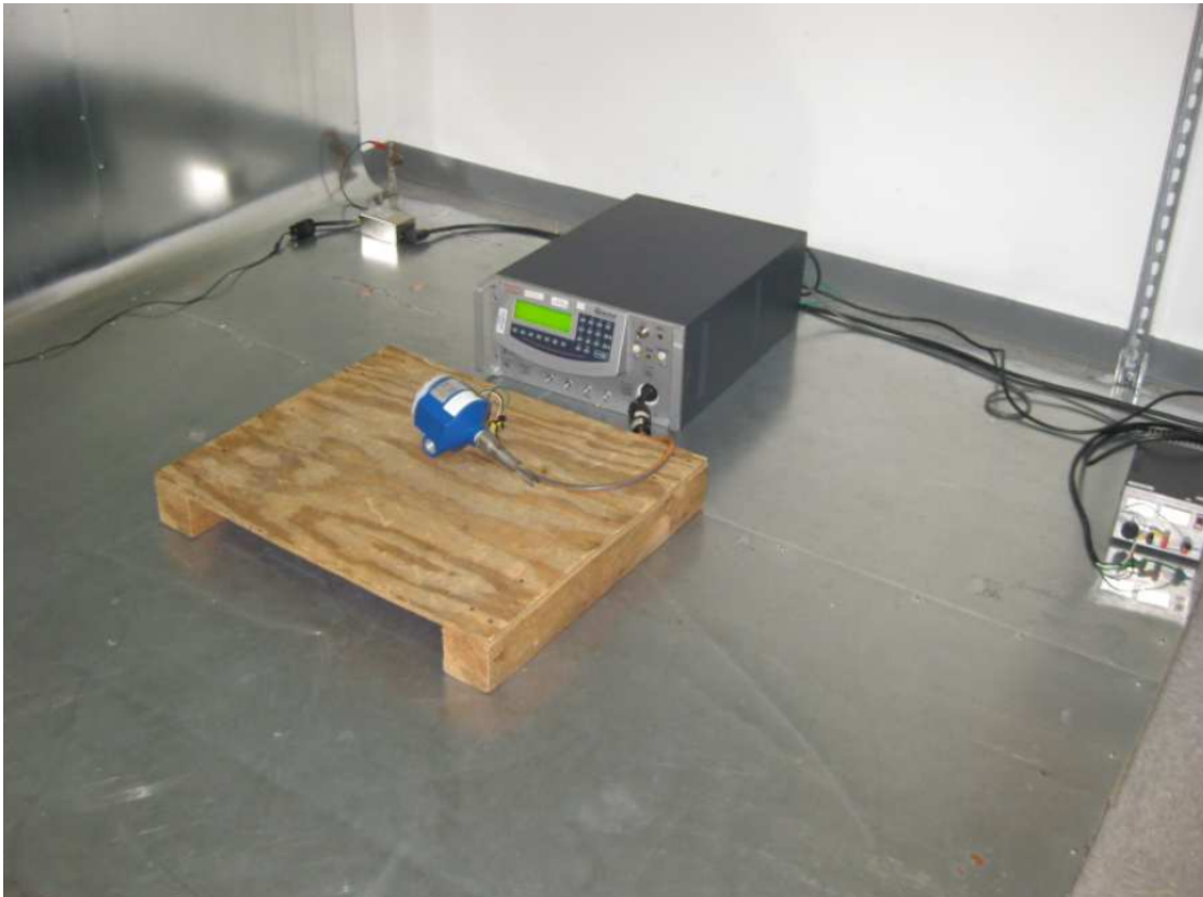
Figura 3.12: Esempio di set-up reale per un'apparecchiatura di tipo floor-standing. [14]
