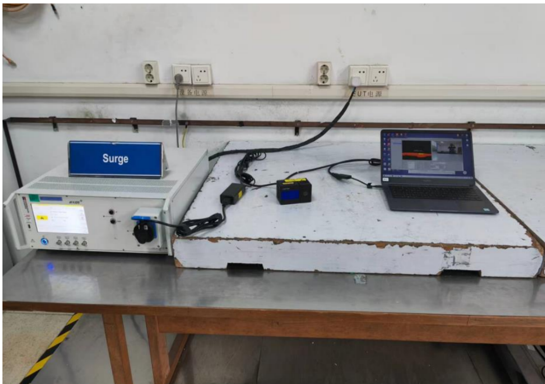
Figura 4.8: Esempio di set-up reale per la prova di immunità ai surge. [17]
