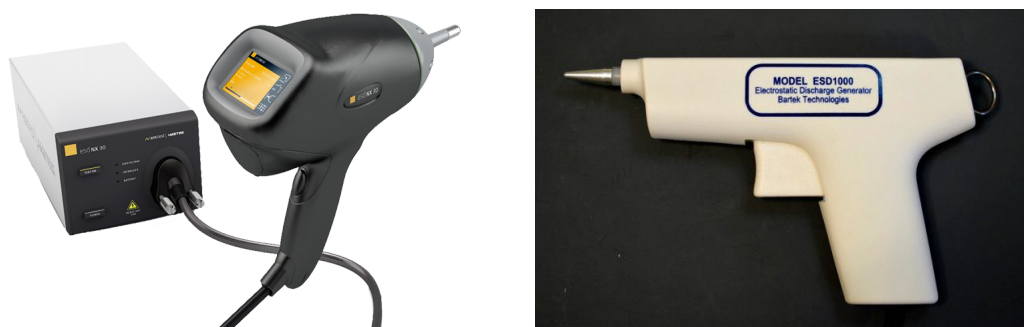
Figura 2.3: Pistole per scariche elettrostatiche. A sinistra, un modello venduto da Volta. A destra, un modello venduto da Bartek. [8] [9]
