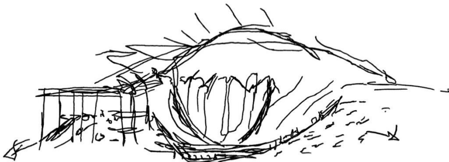
Figura 38. Schizzo che rappresenta la rottura del vaso a causa delle forze di erosione dell'acqua e pressione dovuta all'ipotetico accumulo sovrastante.
