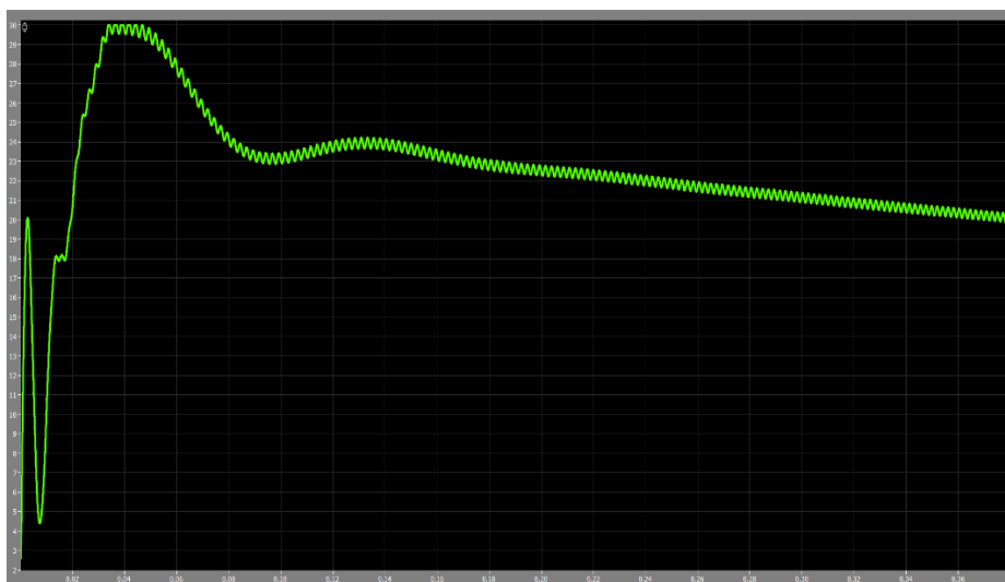
Figura 5.20: Segnale che fornisce l'ampiezza della corrente di riferimento, a velocità crescente
