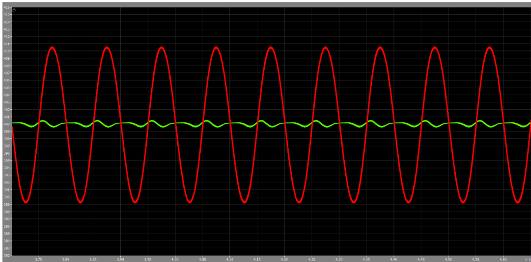
Figura 4.10: Tensione d'uscita (in rosso) e valore medio in uscita dal filtro (in verde)
