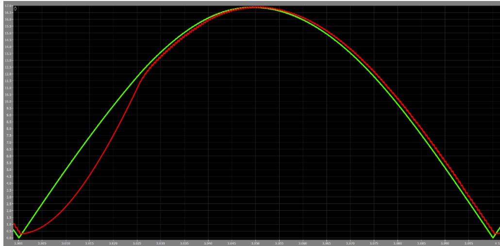
Figura 4.30: Corrente effettiva e riferimento con induttanza di valore 20mH
