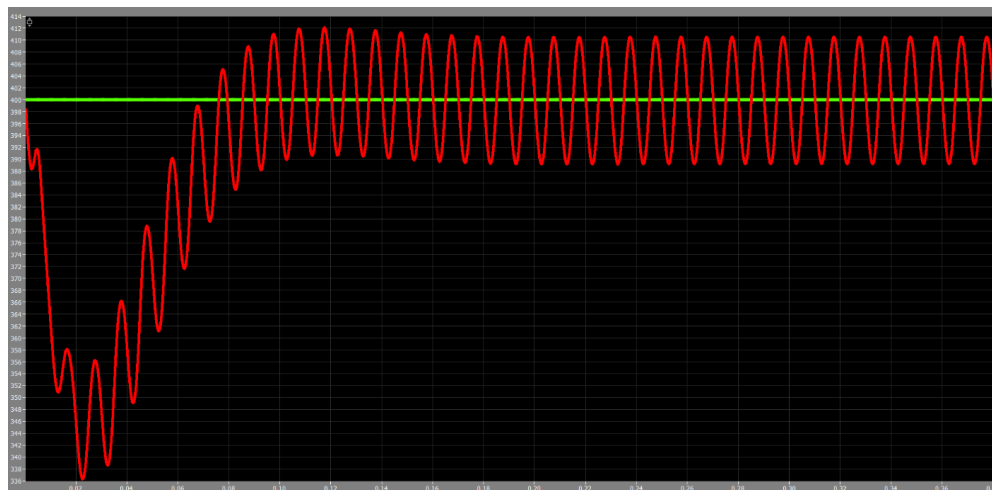
Figura 4.27: Segnale di riferimento per il valore medio della tensione di uscita (verde) e comportamento effettivo della tensione di uscita (rosso) con K_P = 0.1 and K_I = 6 .
