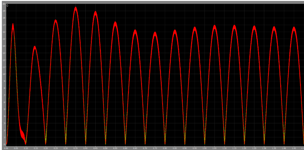
Figura 4.23: Segnale di riferimento per la corrente nell'induttanza (verde) e andamento effettivo della corrente nell'induttanza (rosso) con K_p = 0.5 .
