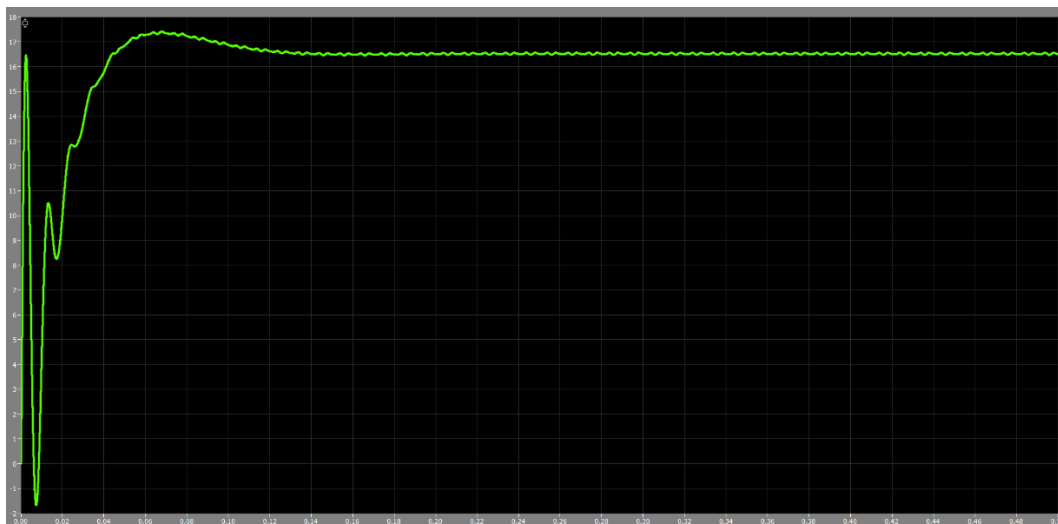
Figura 4.11: Ampiezza della corrente di riferimento in uscita dal PI di tensione, a regime è costante perché la tensione di alimentazione non varia
