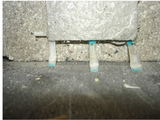
Fig. 6.48 - Esito della prova di taglio diretto per il provino DS_GS25_450_55_1.
