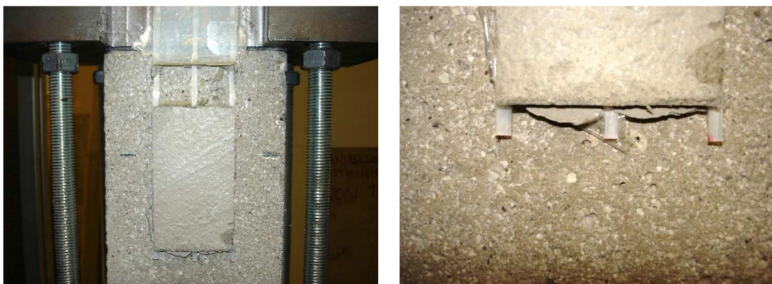
Fig. 6.38 - Esito della prova di taglio diretto per il provino DS_GS25_100_55_4.
