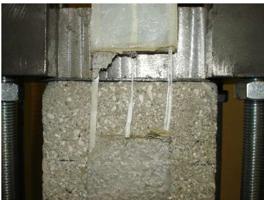
Fig. 6.49 - Esito della prova di taglio diretto per il provino DS_GS25_450_55_2.
