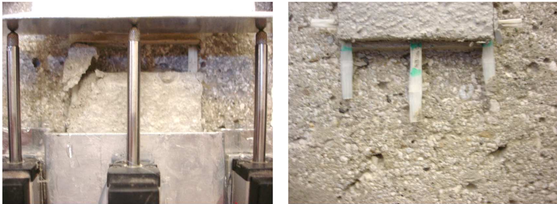
Fig. 6.44 - Esito della prova di taglio diretto per il provino DS_GS25_330_55_1.
