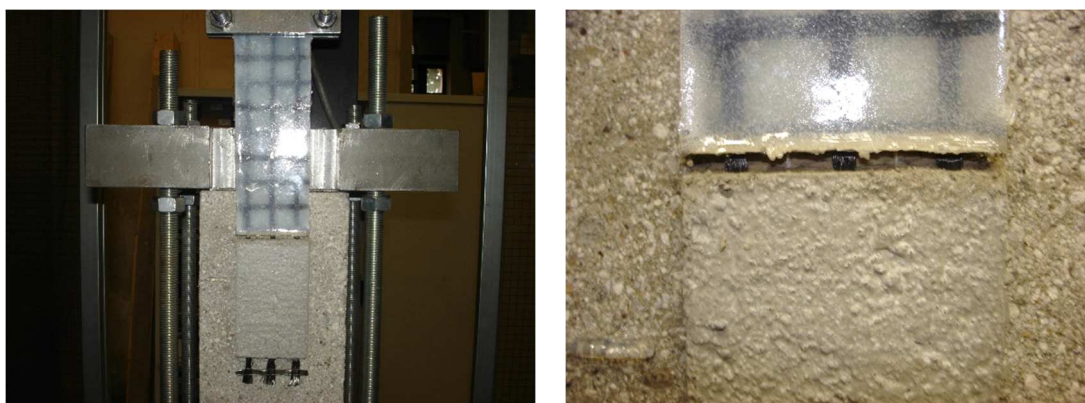
Fig. 6.2 – Esito della prova di taglio diretto per il provino DS_CS17_100_60_1.
