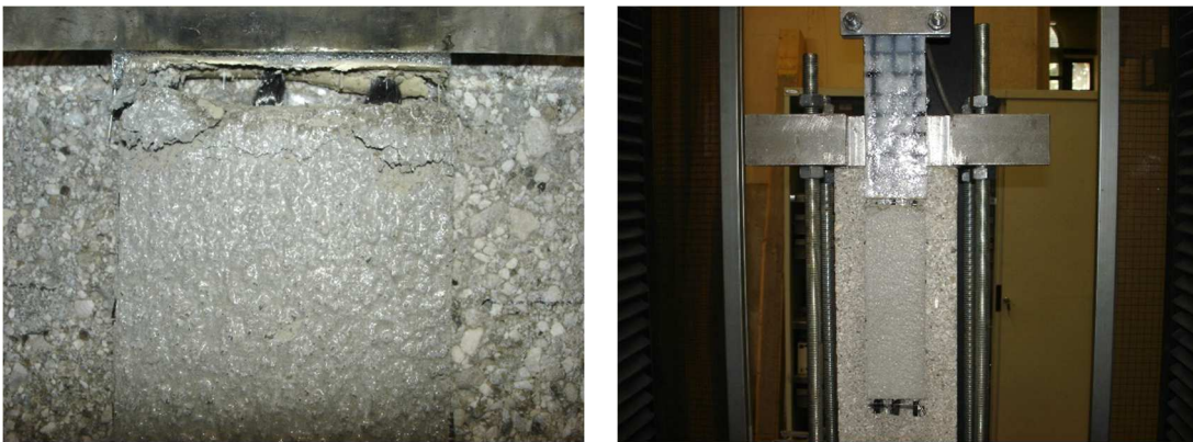
Fig. 6.7 - Esito della prova di taglio diretto per il provino DS_CS17_200_60_3.
