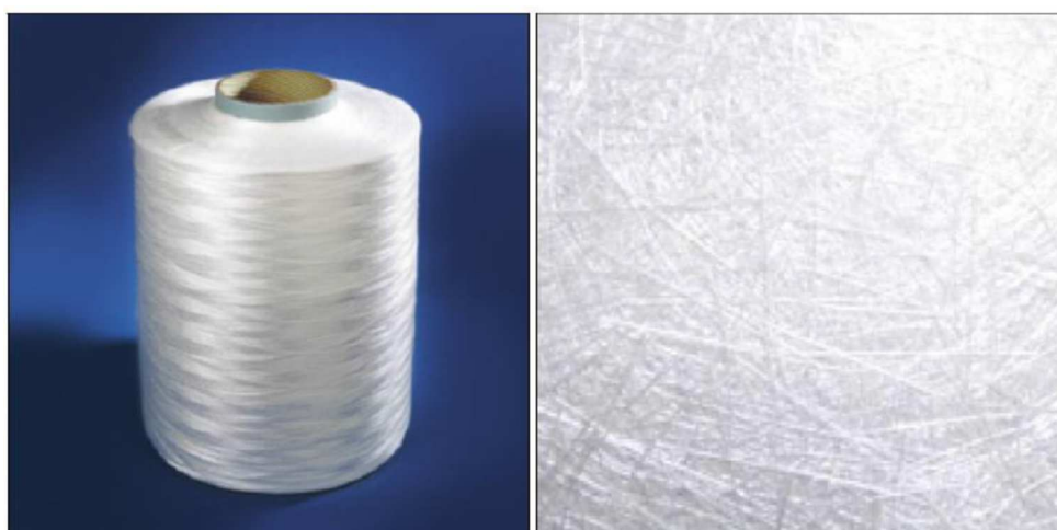
Fig. 2.4 – Yarn (a sinistra) e Mat (a destra) in fibra di vetro. [13]
