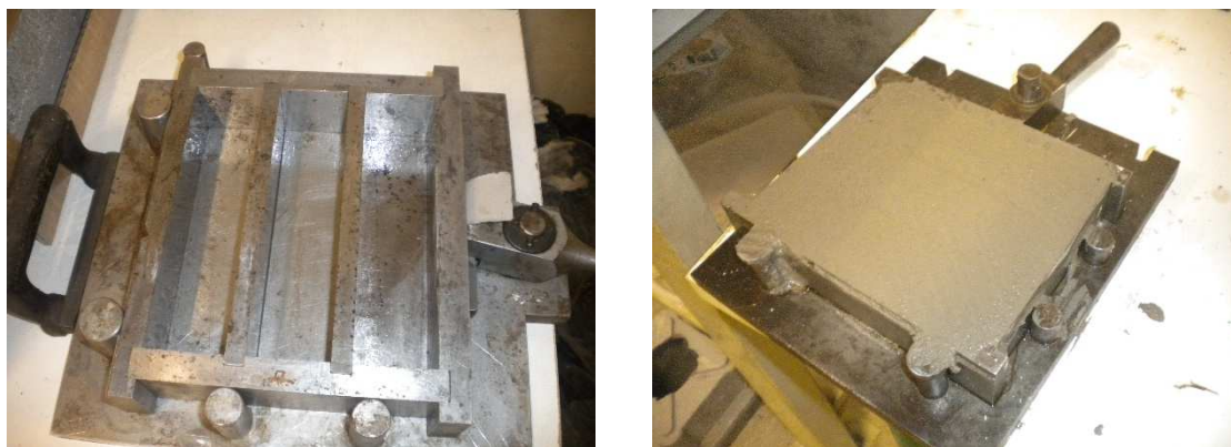
Fig. 4.4 – Cassero per il confezionamento di tre provini in malta, dimensioni 40x40x160 mm.
