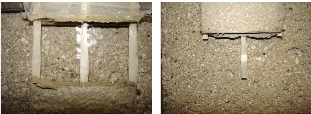
Fig. 6.42 - Esito della prova di taglio diretto per il provino DS_GS25_200_55_4.
