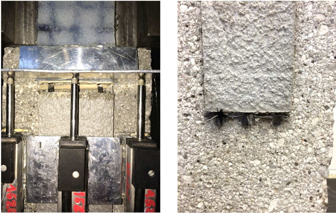
Fig. 6.9 - Esito della prova di taglio diretto per il provino DS_CS17_330_60_2.
