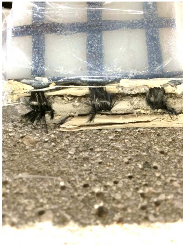
Fig. 6.10 – Particolare della rottura delle fibre del provino DS_CS17_330_60_3.
