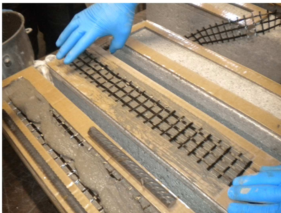
Fig. 5.3 – Applicazione del rinforzo in fibra C-NET 170BL sullo strato inferiore della matrice.
