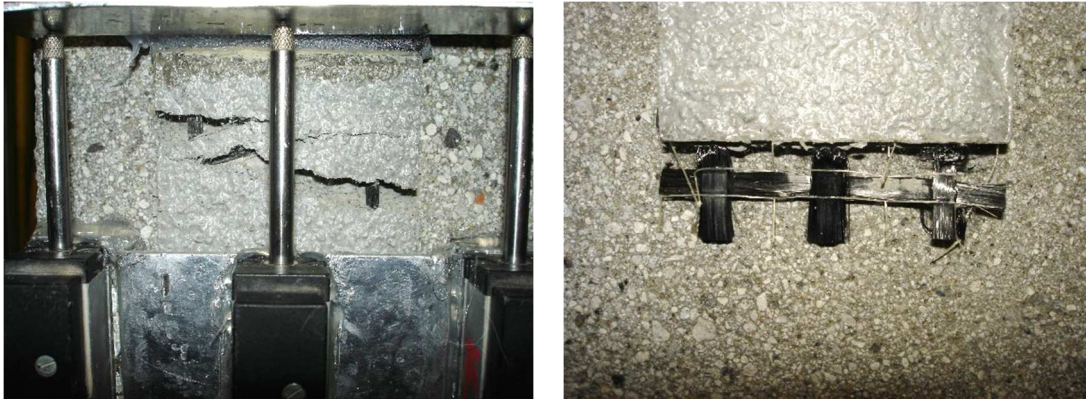
Fig. 6.6 - Esito della prova di taglio diretto per il provino DS_CS17_200_60_2.
