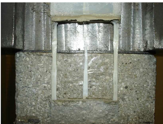
Fig. 6.50 - Esito della prova di taglio diretto per il provino DS_GS25_450_55_3.
