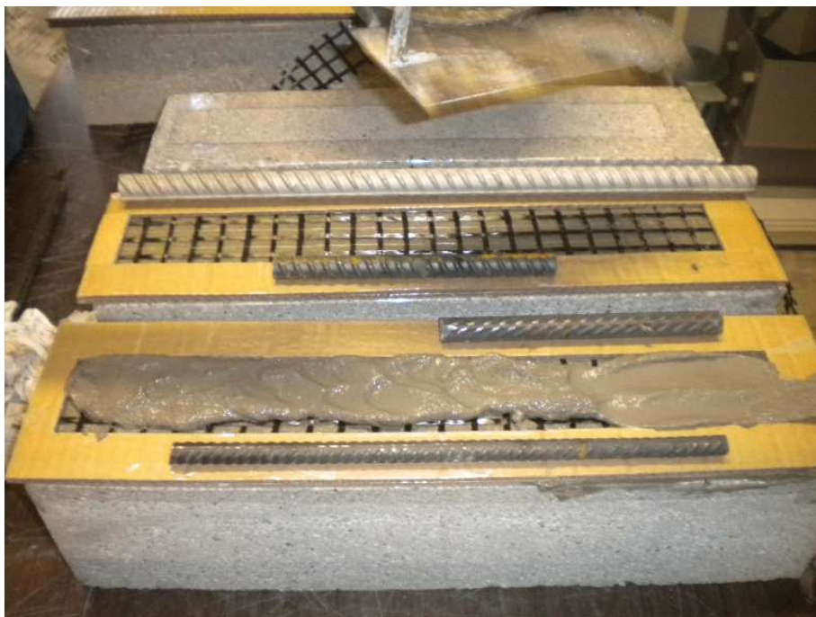
Fig. 5.4 – Applicazione dello strato esterno di matrice, confinata dal cassero superiore.
