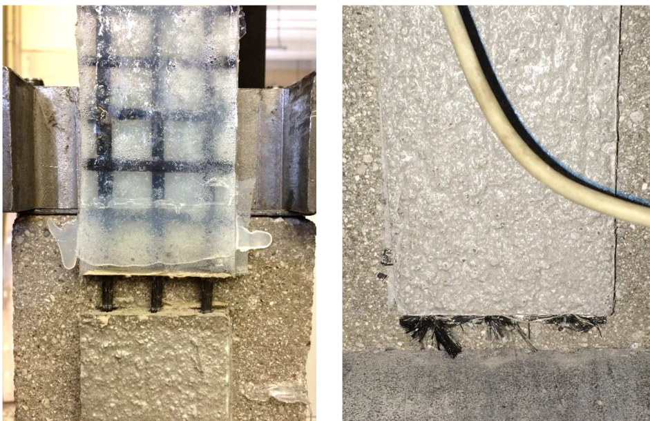
Fig. 6.14 - Esito della prova di taglio diretto per il provino DS_CS17_450_60_2.
