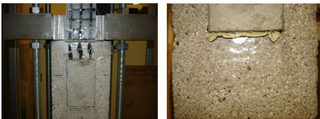
Fig. 6.3 - Esito della prova di taglio diretto per il provino DS_CS17_100_60_2.
