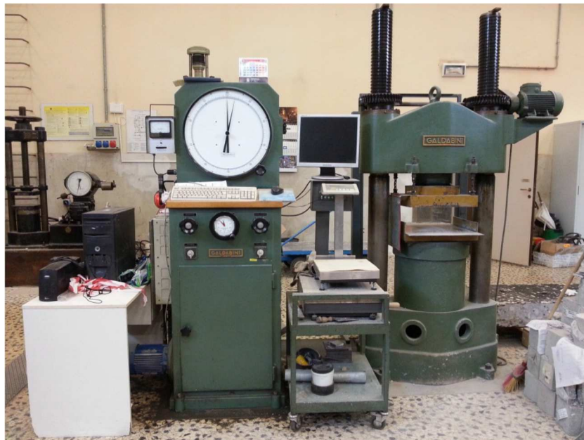
Fig. 4.1 – Macchina universale elettromeccanica Galdabini. [9]
