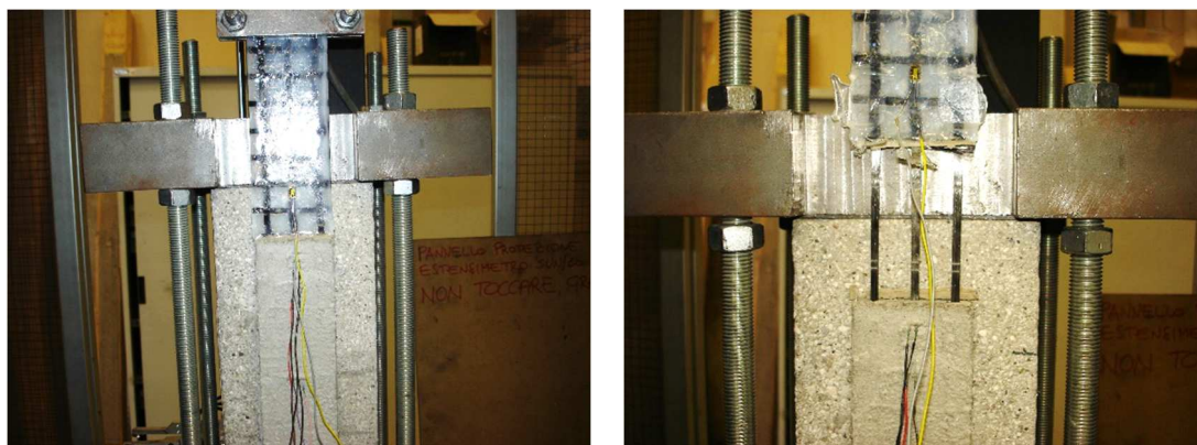
Fig. 6.22 - Esito della prova di taglio diretto. Particolare della parte superiore della matrice.
