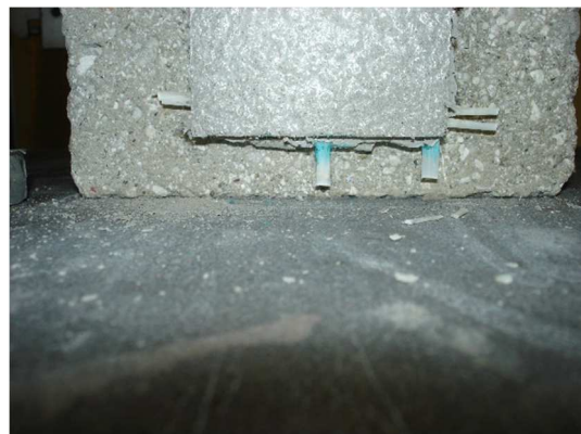
Fig. 6.49 - Esito della prova di taglio diretto per il provino DS_GS25_450_55_2.
