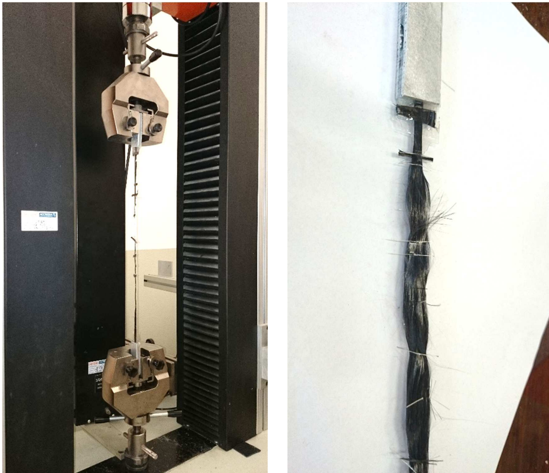
Fig. 4.9 – A sinistra, set up delle prove di trazione. A destra, particolare della rottura di un provino.
