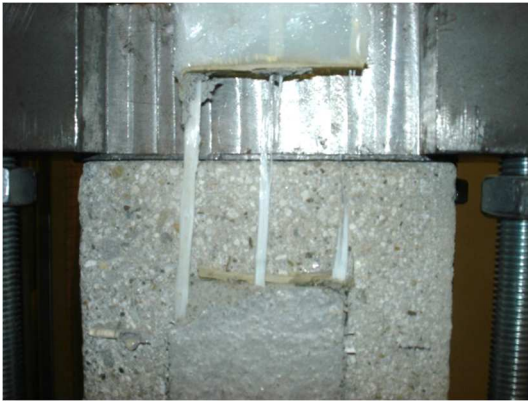
Fig. 6.48 - Esito della prova di taglio diretto per il provino DS_GS25_450_55_1.
