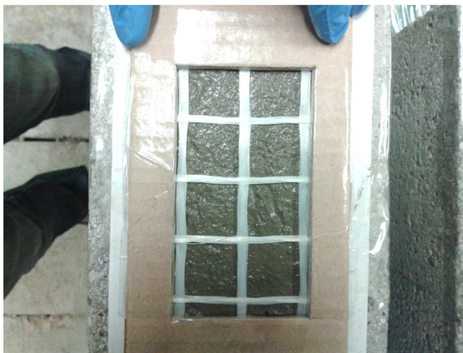
Fig. 5.7 – Vista del rinforzo G-NET 251BA prima della stesura dello strato superiore della matrice.
