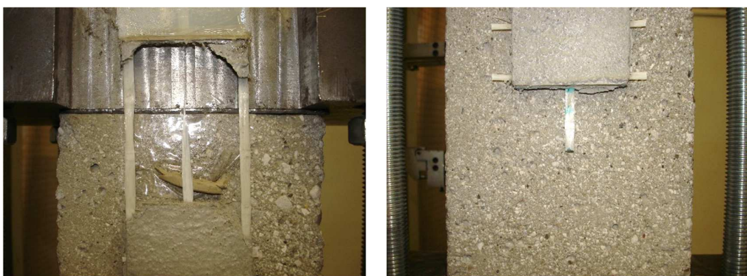
Fig. 6.46 - Esito della prova di taglio diretto per il provino DS_GS25_330_55_3.
