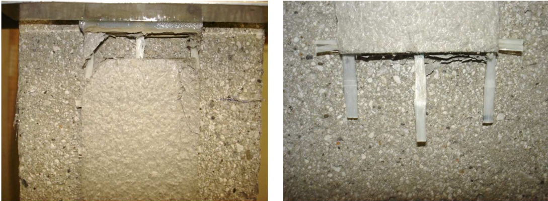
Fig. 6.40 - Esito della prova di taglio diretto per il provino DS_GS25_200_55_2.
