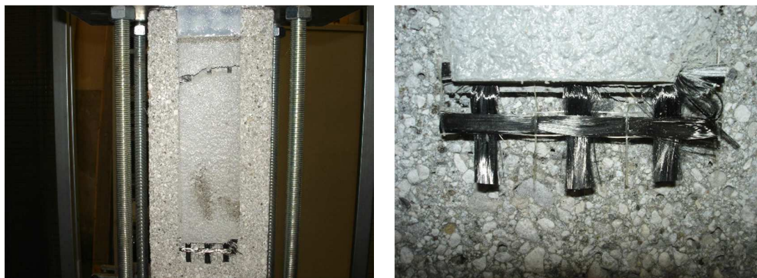
Fig. 6.5 - Esito della prova di taglio diretto per il provino DS_CS17_200_60_1.
