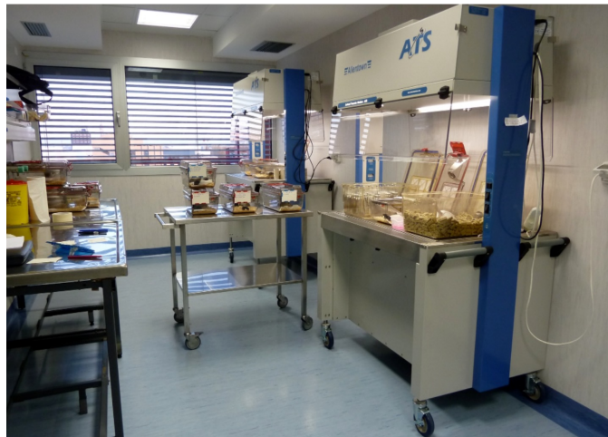
Figura 8: Cappa a flusso laminare verticale con filtro HEPA. Polo Multifunzionale A. Vallisneri, Università degli Studi di Padova.
