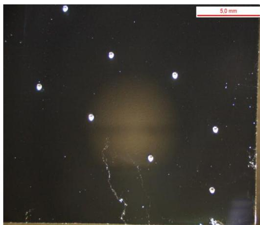
Figura 5.38 – Immagine Stereoscopio per evidenziare la comparsa di cricche
