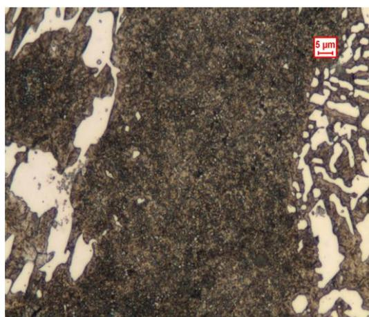
Figura 5.60 - Micrografia vista 500x cuore
