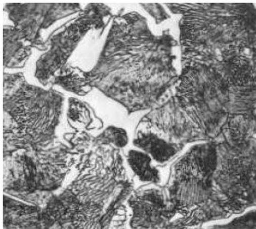
*Figura 1.8 - Micrografia 1000x acciaio C = 1.5%, ipereutetoidico.*
