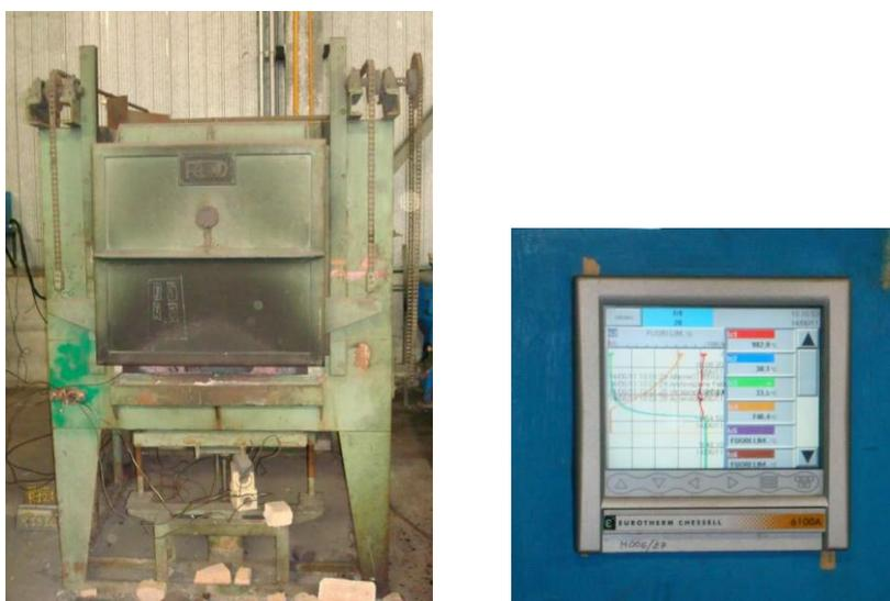
Figura 4.2 – Forno per trattamenti presso "Safas S.p.A.", e relativo pannello di controllo
