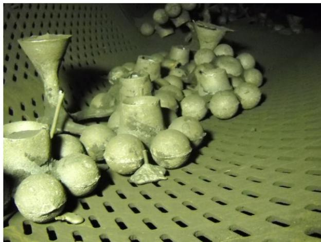
*Figura 3.5 – Separazione dei pezzi dalla terra da fonderia*
