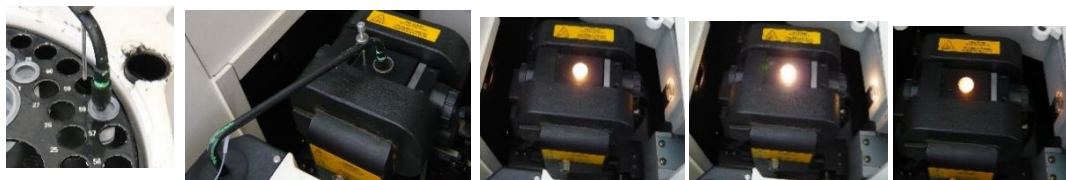
Figura 34: Partendo da sinistra si può notare il prelievo del campione, la successiva iniezione e le diverse fasi dell'atomizzazione del campione iniettato nel fornello di grafite (ultime tre immagini).
