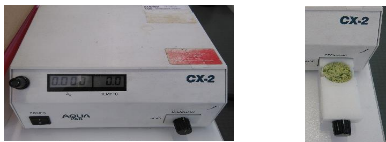
Figura 28: Strumento per la determinazione dell'attività dell'acqua a destra si può notare il cassetto porta campione estraibile con la capsula inserita.
