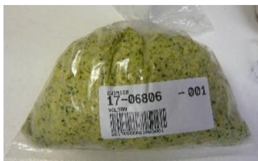
Figura 25: Particolare dell'impasto chiuso nel sacchetto ed identificato mediante codice univoco.
