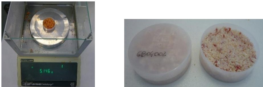
Figura 27: Dosaggio del campione e particolare delle capsule con e senza coperchio.
