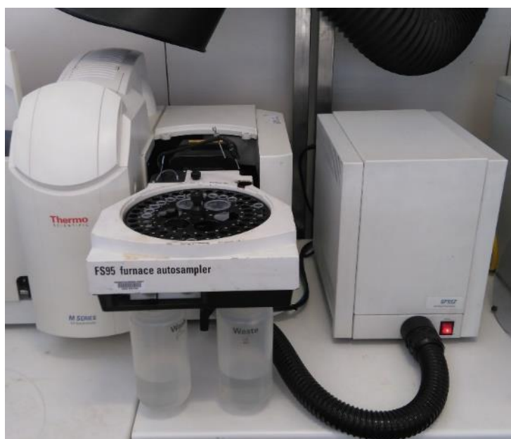
Figura 32: Partendo da destra si può notare il correttore del forno Zeeman, al centro la fornace con l'autocampionatore e a sinistra il sistema di rilevazione.
