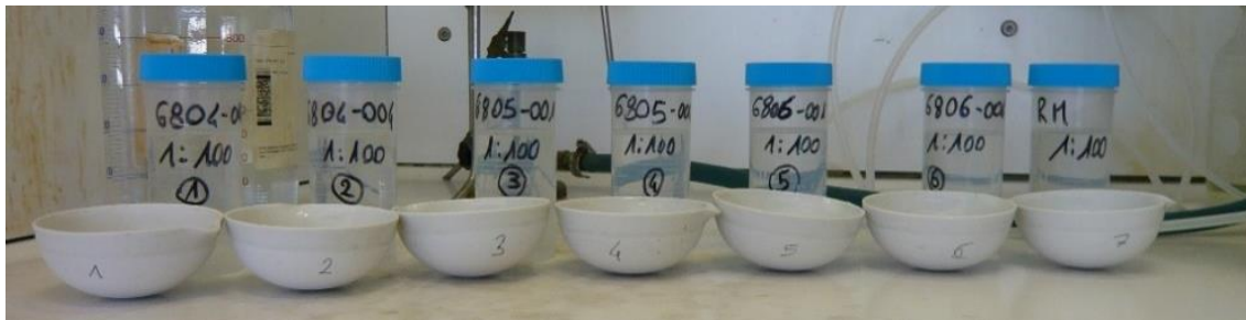
Figura 30: Particolare dei crogioli numerati e dei contenitori Digitub da 100 ml identificati.
