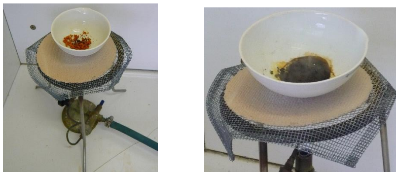
Figura 29: Particolare della fase di carbonizzazione del campione a destra si può notare il campione quasi carbonizzato.
