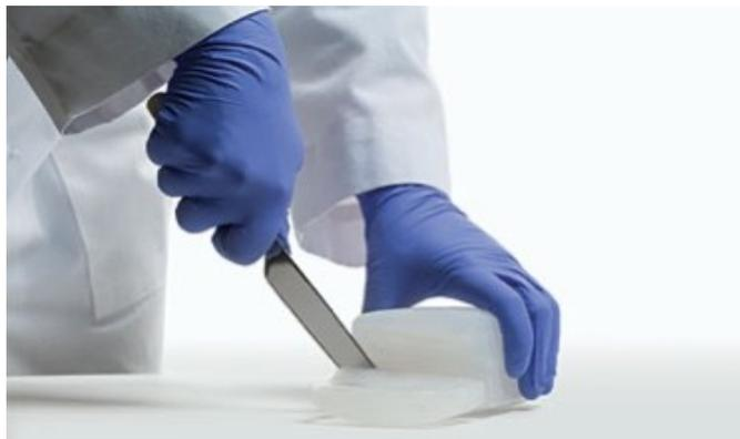
Fig. 4.1 Gli elastomeri di silicone sono realizzati con una combinazione di polimeri lineari, agenti rinforzanti, un agente di reticolazione e un catalizzatore. Posseggono un'elevata deformabilità prima del punto di rottura e notevole resistenza allo strappo, e la loro estrema biocompatibilità li rende candidati per applicazioni protesiche.
