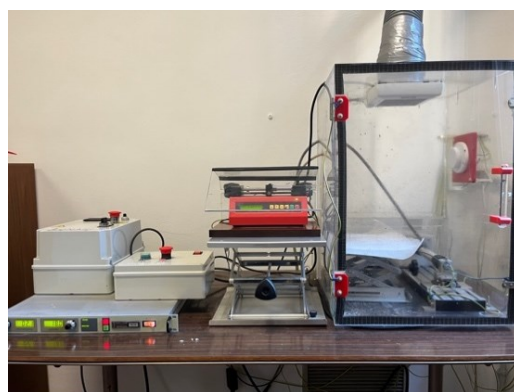
Figura 10 - Strumentazione di elettrospinning utilizzata nel progetto di tesi.
