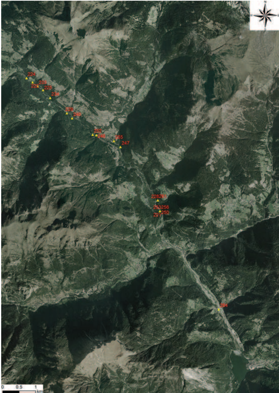
Figura 5.20 - Elaborazione Gis raffigurante la distribuzione degli elementi legnosi movimentati nel momento del monitoraggio post evento
