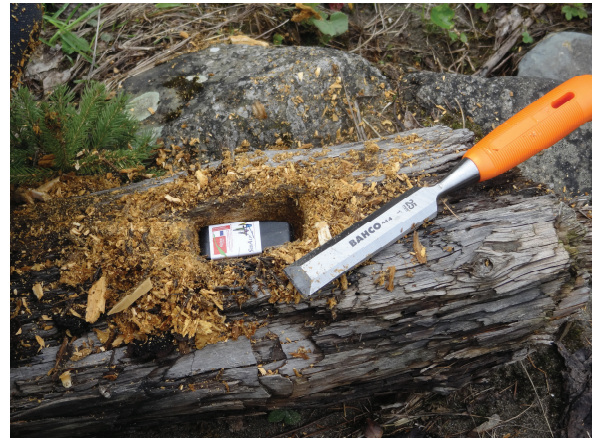
Figura 3.10 – Inserimento tag RFID
