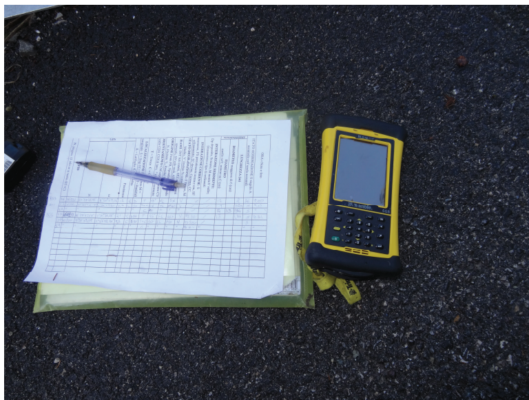
Figura 3.3 – Scheda di campo e palmare Nomad Trimble utilizzati durante la fase di installazione dei trasmettitori
