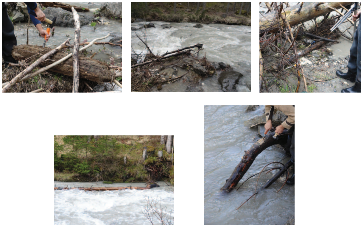
Figura 5.24- Immagini relative ai LW in fase di installazione RFID, poi non ritrovati
