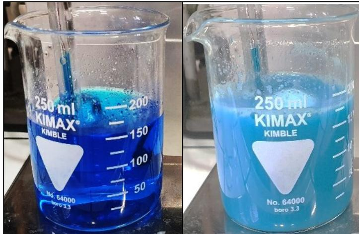
Fig. 3.4 – Soluzione di deposizione con  $Zn(NO_3)_2$  a pH 5 (a sx) e a pH 6.1 (a dx).
