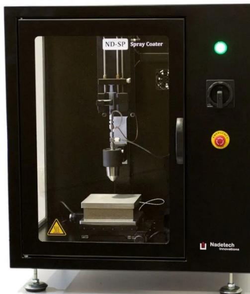
Fig. 2.11 – Spray coater utilizzato per la deposizione di  $\text{g-C}_3\text{N}_4$ .
