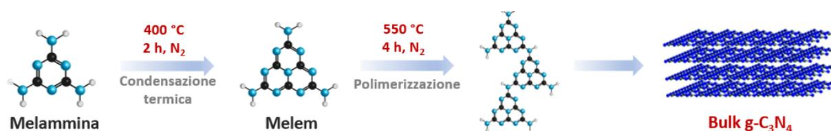
Fig. 4.3 – Sintesi termica di g-C<sub>3</sub>N<sub>4</sub> usando la melammina come precursore.
