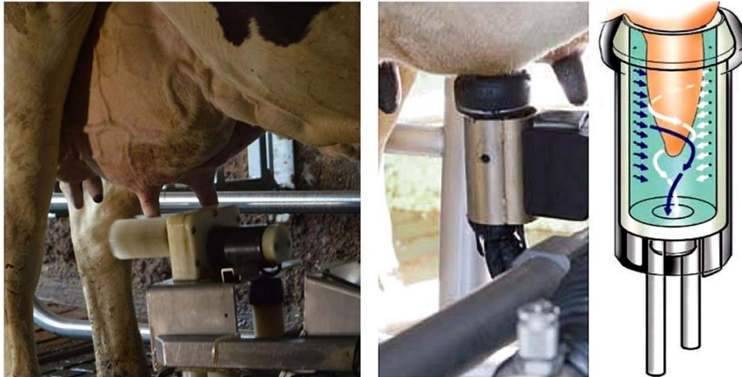
Figura 2.2.3: Sistemi di pulizia automatici dei capezzoli. A destra viene effettuato da un sistema prendicapezzolo autopulente, a sinistra da spazzole rotanti (Pessina, 2017).
