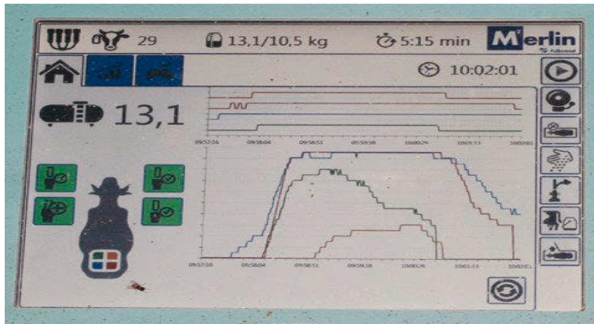
Figura 2.3.4: Monitor dell'AMS dove è possibile osservare il numero identificativo della vacca, la curva di lattazione per ogni singolo quarto, la quantità di latte prodotta durante la mungitura, il tempo di occupazione dell'AMS e il tempo di mungitura.
