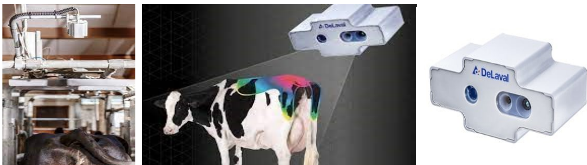
Figura 2.3.3: Sensore ottico 3D mentre sta effettuando una scansione dell'animale in uscita dall'AMS.
